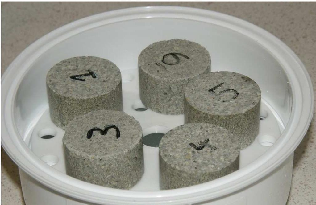
[Figure II.1](#) Bouchons (ou plugs) de bentonite-sable de diamètre 36,7mm et 25mm de hauteur, juste après compactage.
