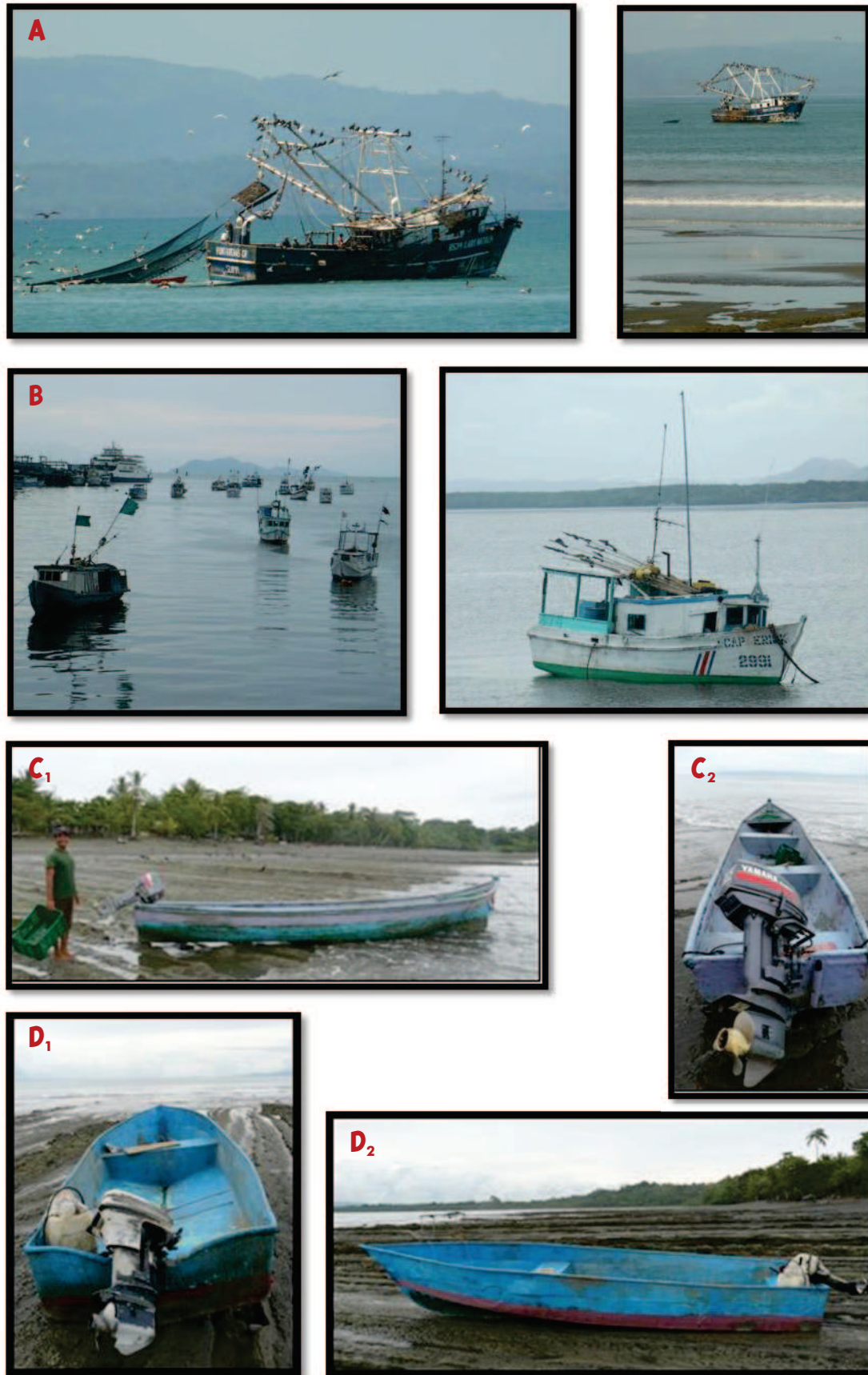
Photographie 3-1. Planche de photographies illustrant les types d'embarcations de différentes flottes halieutiques costaricaines. A , Bateau crevettier de type « Florida » (flotte SI), B , lancha palangrière (flotte AM), C , bote (flotte APE et MANUAL), D , panga (flotte APE).
