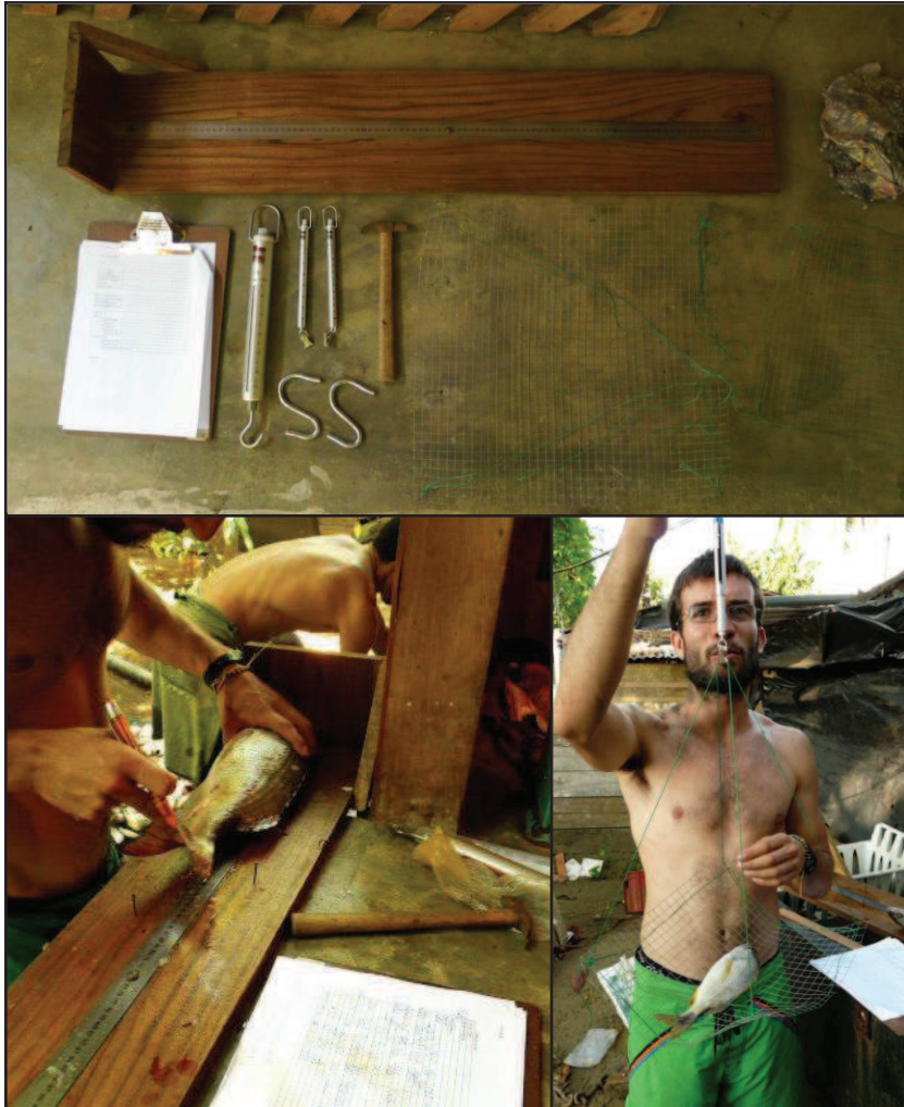
Photographie 2-4. Suivi biologique des débarquements à Puerto Pilón. En haut, matériel utilisé pour le suivi : ichtyomètre de « fabrication artisanale » d'un mètre ; carnet de capture ; marteau et clous pour fixer les nageoires et arêtes pour la photo-identification ; balances mécaniques de précision Pesola® : 5000 ± 25 g ; 1000 ± 10 g et 300 ± 5g ; plateau en grillage fin et léger pour les pesées ; chiffon. En bas à gauche, mesure de la taille d'un individu. En bas à droite, pesée d'un individu.
