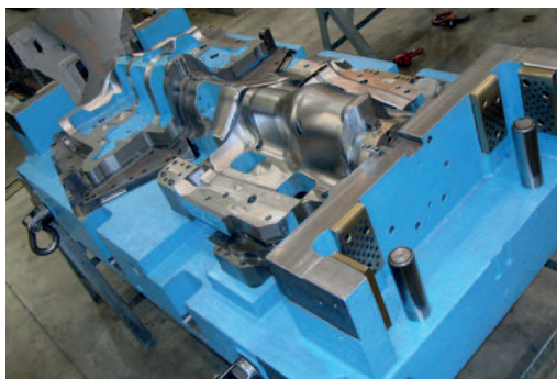
FIGURE 1.1 – Matrice d'emboutissage pour la réalisation d'un bouclier thermique Général Motors*
