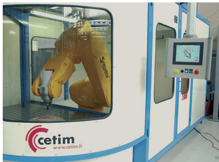
FIGURE 1 – Cellule d'usinage robotisé du CETIM
