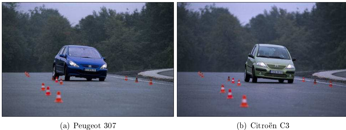
FIG. 2.16 – Les sollicitations dynamiques lors d’un test VDA à 70 km/h sont fortes
