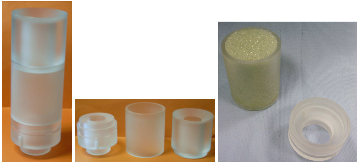
Figure 2.20 – Pore modèle de 7cm (assemblé à gauche et en trois morceaux au centre) et poreux avec des billes collées (à droite)
