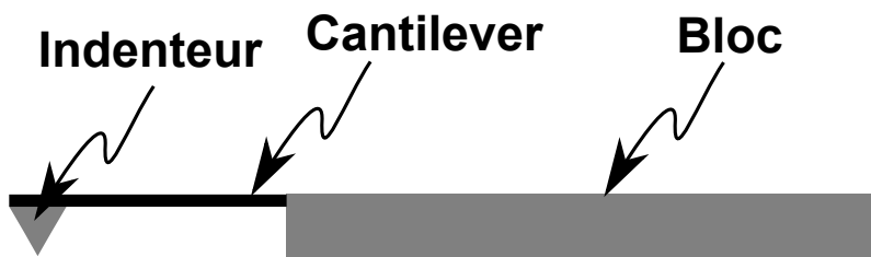
Figure 2.10 – Schéma représentant la configuration de tous types d'indenteurs destinés aux AFM.
