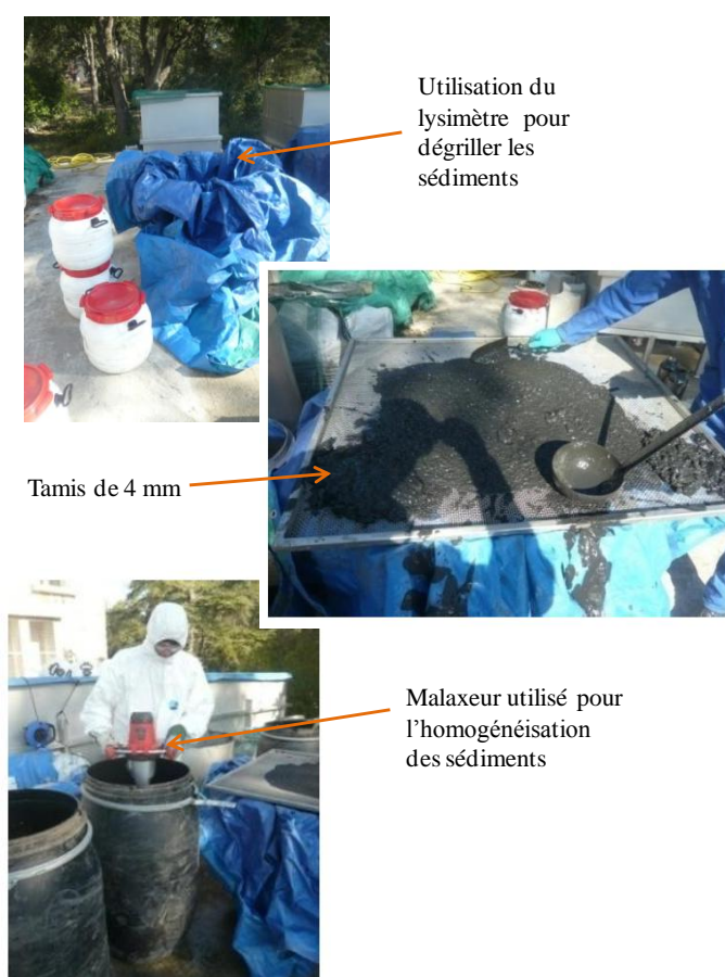
Figure 2-2 : Tamisage et homogénéisation des sédiments
