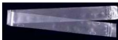
Figure 5-5 : Photographie d'un échantillonneur passif de type SPMD
