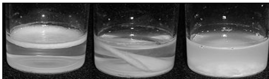
Figure 18 : Apparition de tricheurs et désintégration du polymère formé par les clones WS (d'après http://evolution.massey.ac.nz/rainey/index.htm ). Un polymère intact est le produit des interactions coopératives de millions de cellules (photographie de gauche). Quand le polymère se fragilise suite à l'apparition de tricheurs, il coule au fond du tube (photographie du milieu). Quand on secoue brièvement le flacon, le polymère se casse en de multiples morceaux, montrant la fragilité acquise (photographie de droite).
