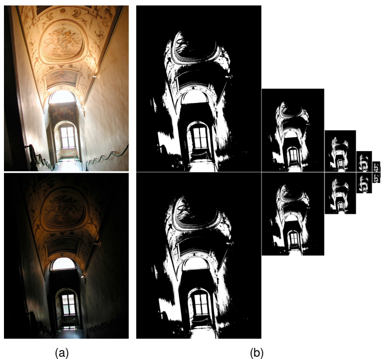
FIGURE 2.14 – Une pyramide MTB (Median Threshold Bitmap) (b) est utilisée pour l'alignement des images d'entrée (a) proposé par Ward [68].
