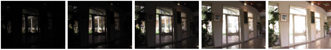
FIGURE 1.2 – Exemple d'une série d'images prises avec des temps d'exposition différents, technique aussi appelée "bracketing". Les images sont tirées du travail de Fattal et al. [17].
