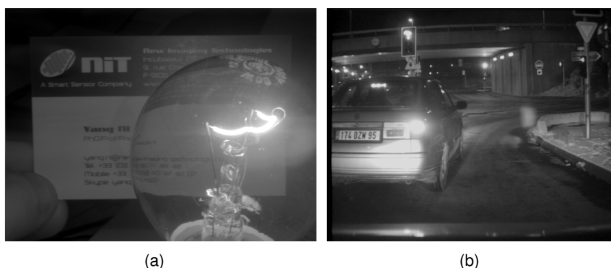
FIGURE 3.3 – Scènes de grande gamme dynamique capturées grâce au capteur logarithmique de Yang Ni et al. [77].
