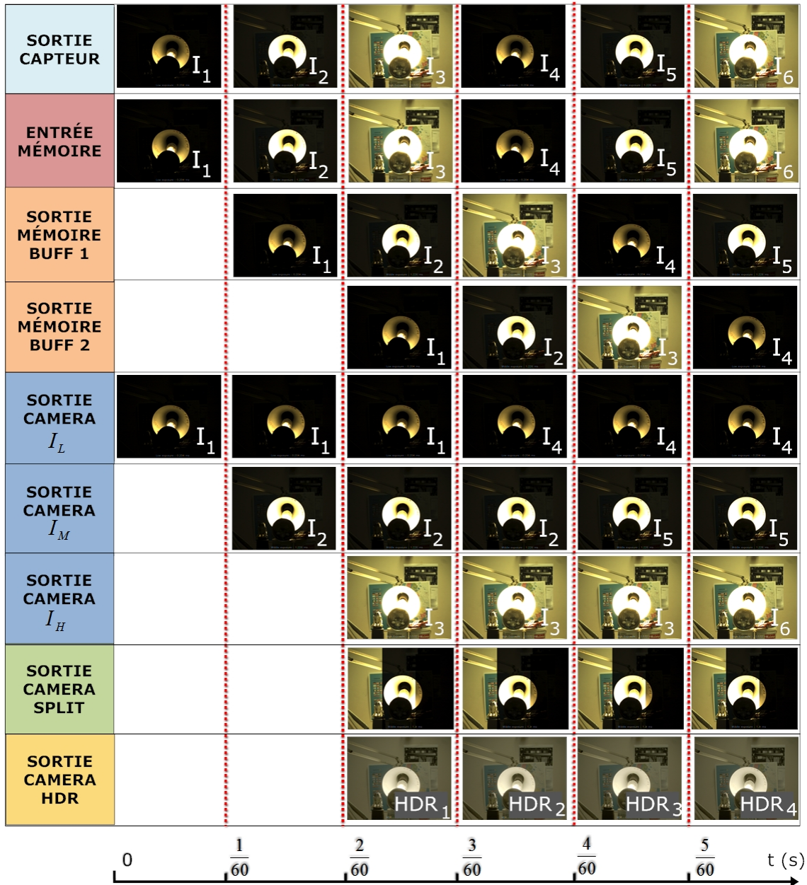
FIGURE D.1 – Les différentes sorties parallélisées du système HDR-ARTiSt.
