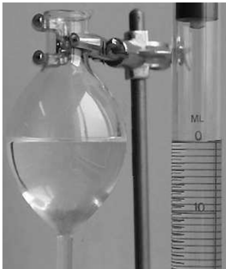
Figure 12 : Mise à niveau de l'eau contenue dans l'ampoule et le tube gradué
