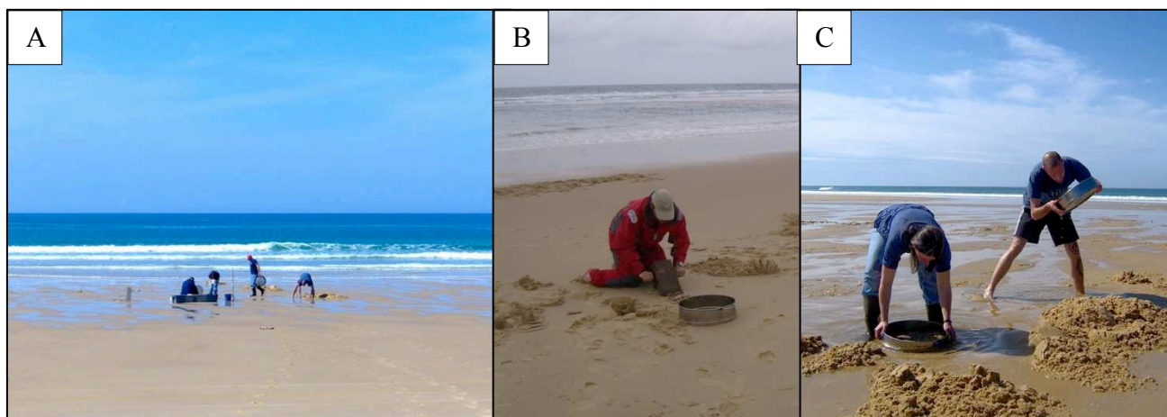
Figure 36 : Photographies de l'échantillonnage sur la plage du Truc Vert ; (A) vue générale, (B) carottage et (C) tamisage.
