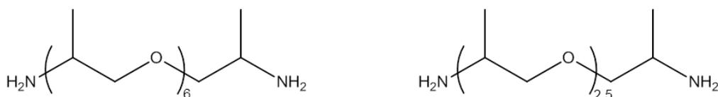
**Figure 21** Formules chimiques des durcisseurs Jeffamine D400 ( $x=6$ ) et Jeffamine D230 ( $x=2,5$ )
