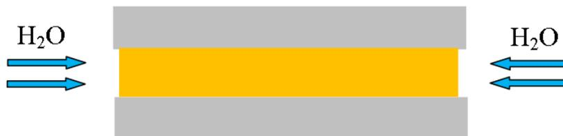
**Figure 55** Pénétration d'eau au sein d'un assemblage collé
