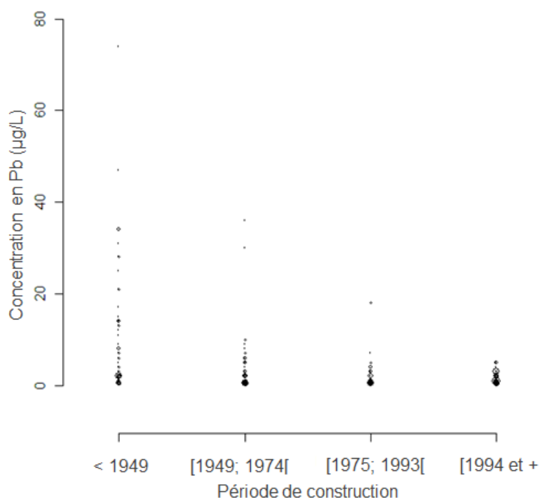
FIGURE 24 – Concentrations en plomb dans l’eau du robinet selon la période de construction.
