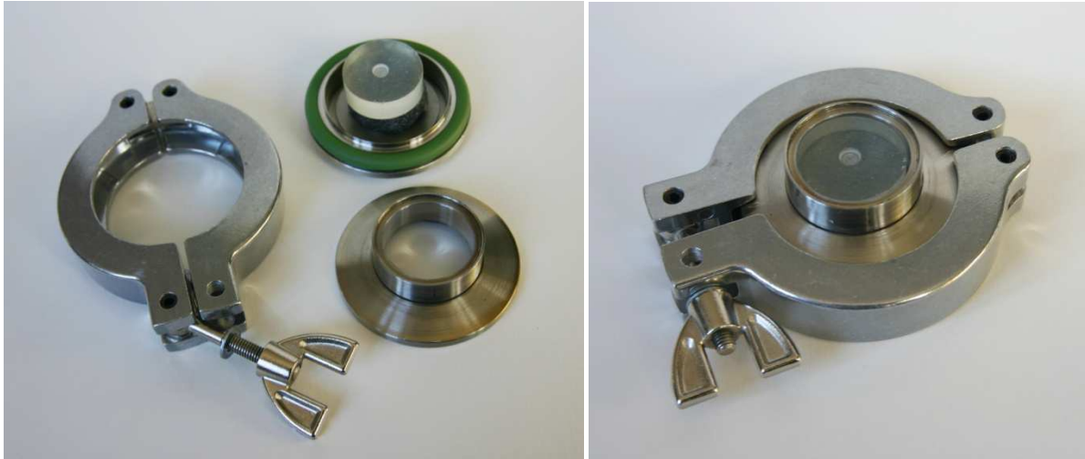
Figure 27: Cellule d'analyse à atmosphère contrôlée
