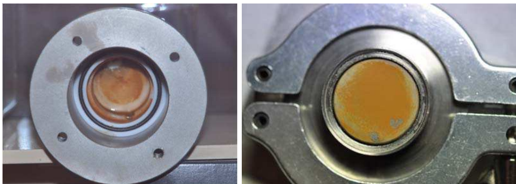
Figure 109: Photographie des précipités en fond de cellule après traitement sans irradiation de l'échantillon GL11_04_B (gauche) et après traitement avec irradiation de l'échantillon GL11_04_C (droite)
