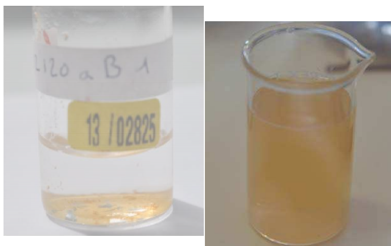
Figure 113: photographie de la solution de l'échantillon non irradié GL12_120a_B (gauche) et de la solution laiteuse de l'échantillon irradié GL12_120a_A (droite)
