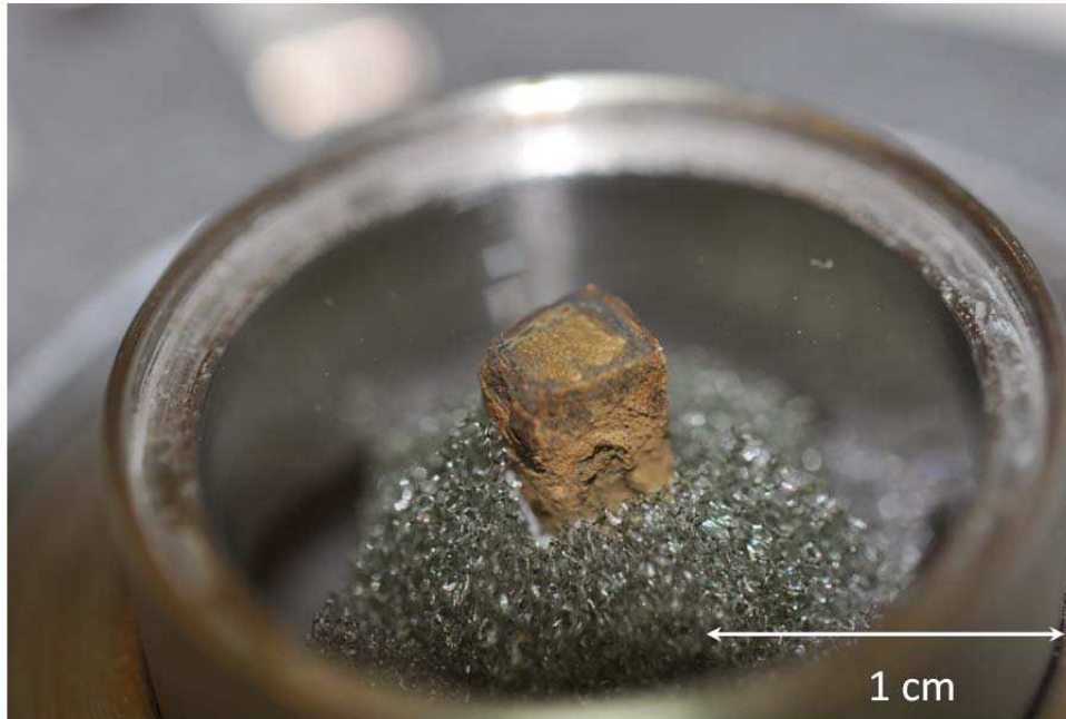
Figure 104: Photographie de la couche de produit de corrosion néoformée après traitement sans irradiation de l'échantillon GL11_04_B
