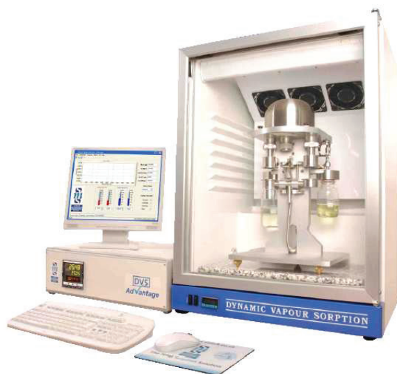
Figure 112 – Le système de sorption de vapeur dynamique (DVS)
