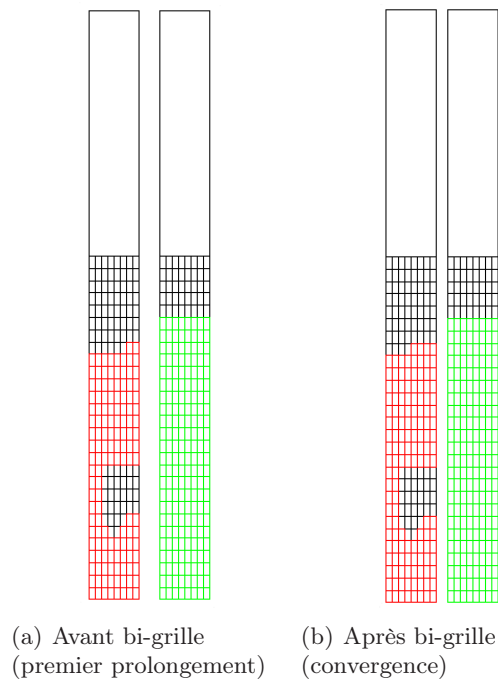
FIGURE III.20 – Zones détectées (en rouge) et raffinées (en vert) avant et après le cycle bi-grille - Cas 2D(r,z) - Élasticité linéaire - h_0 = h_i et l = 1
