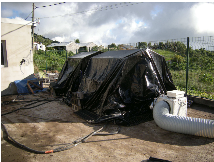
Figure 24. Cellules de mesure des concentrations gazeuses pour deux andains
