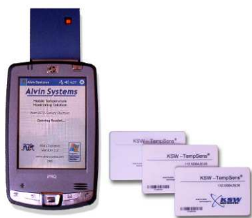
(a) Système de mesure de température KSW Microtec TempSens
