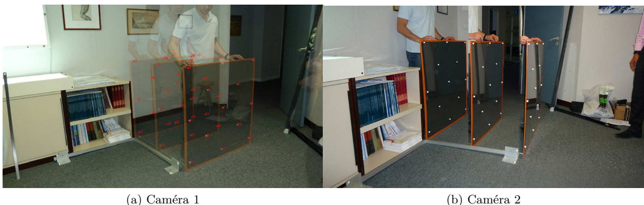
Fig. 4.22 – Calibrage des caméras
