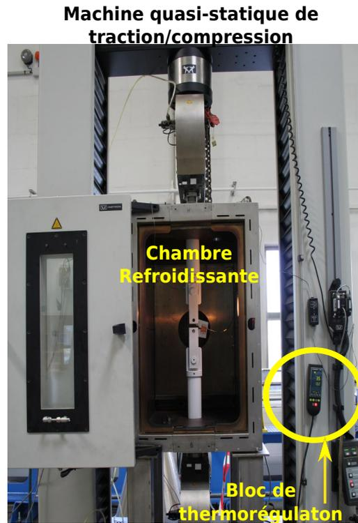
**FIGURE 4.2:** Banc d'essai : machine conventionnelle INSTRON + enceinte refroidissante
