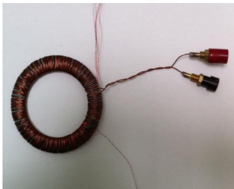
Figure 5.2. Bobinages primaire et secondaire des échantillons de matériaux ferromagnétiques en vue de leur caractérisation magnétique.
