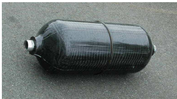
(a) Réservoir issu du procédé RTM
