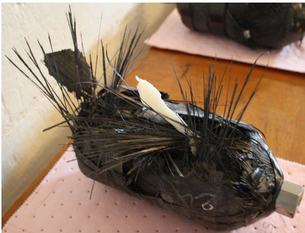
Figure 2 – Éclatement expérimental d'un réservoir en virole.
