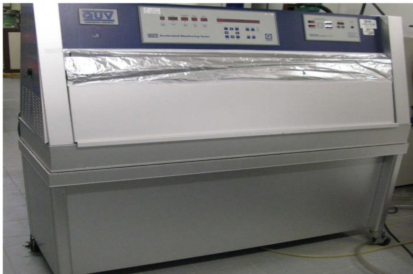
Figure 2.10. Dispositif du vieillissement UV artificiel
