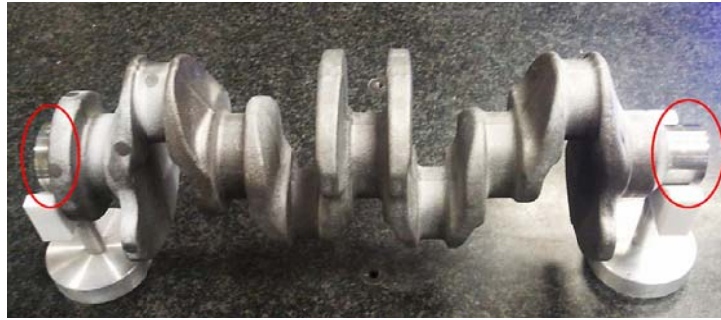
Figure 4 : Surfaces cylindriques usinées aux extrémités du vilebrequin (encadrées en rouge).
