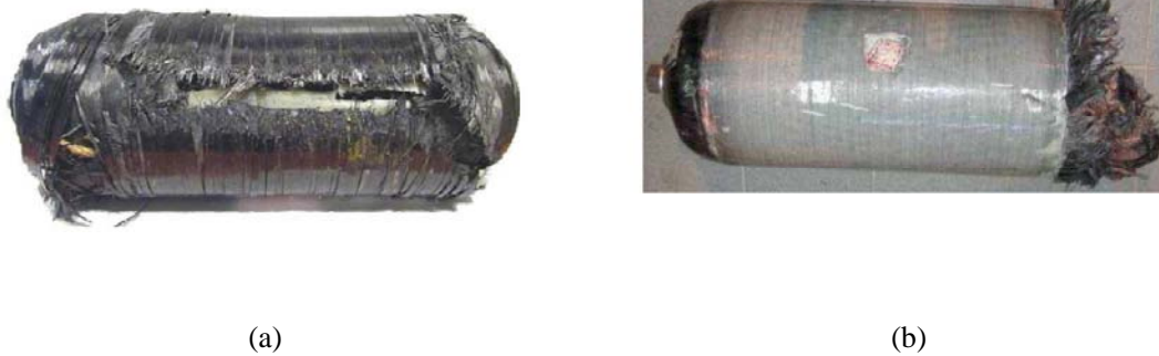
Figure 1.6 : Mode de rupture d'un réservoir (a) sain et (b) non sain (Bertin et al., 2011)
