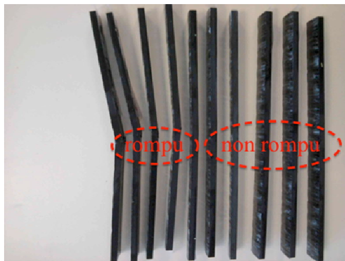
Figure 2.29 : Observation macroscopique des éprouvettes de 5.6mm d'épaisseur
