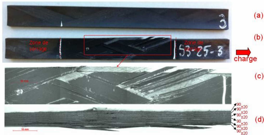
Figure 2-38 : Etat initial (a) et à rupture (b) de l'éprouvette de la structure 3 sous traction simple, agrandissement de la zone de rupture sur la face arrière (c) et sur le bord d'éprouvette (d)
