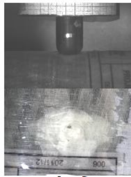
Figure 1.7 : Impacteur à tête hémisphérique et trace d'impact
