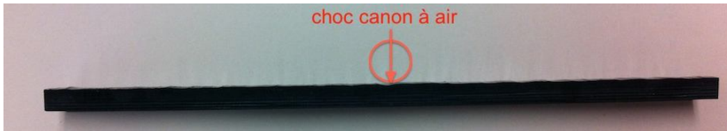
Figure 2.18 : Etat « délamination » simple d'une éprouvette soumise d'impact de 11.5J d'énergie
