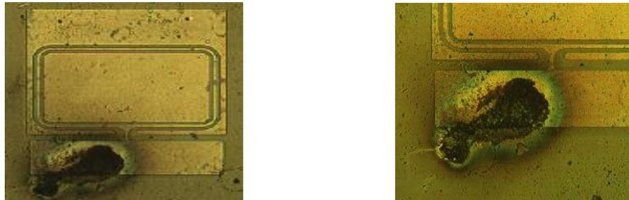
Figure 65 : image des JFET type P après claquage dans l'air sous une tension égale à  $100 \text{ V}$ .
