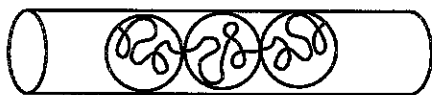
Figure 3.12: Chaîne confinée dans un tube. Le diamètre D du tube est inférieur au rayon de giration R_{nc} de la chaîne non confinée. La conformation de la chaîne est non perturbée aux échelles inférieures à D . Au-delà, la chaîne de blobs est une marche aléatoire à une dimension.
