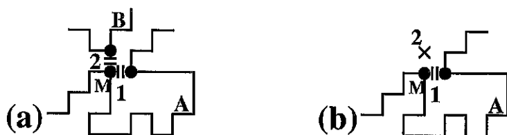
Figure 3.19: (a) Absence de volume exclu dans un fondu. Un monomère M de la chaîne A subit une interaction semblable de la part d'autres monomères de la même chaîne (1) et de la part de monomères d'autres chaînes (2). (b) Volume exclu pour une chaîne isolée. Le monomère M ne subit plus d'interaction de volume exclu de la part des molécules de solvant (2), mais seulement de la part de monomères de la même chaîne A .
