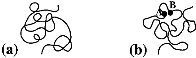
Figure 3.15: (a) Chaîne polymère fantôme. En plusieurs points, deux monomères occupent la même position. (b) Chaîne avec volume exclu. Le monomère B , au contact du monomère A , n'a plus son entière liberté d'orientation.
