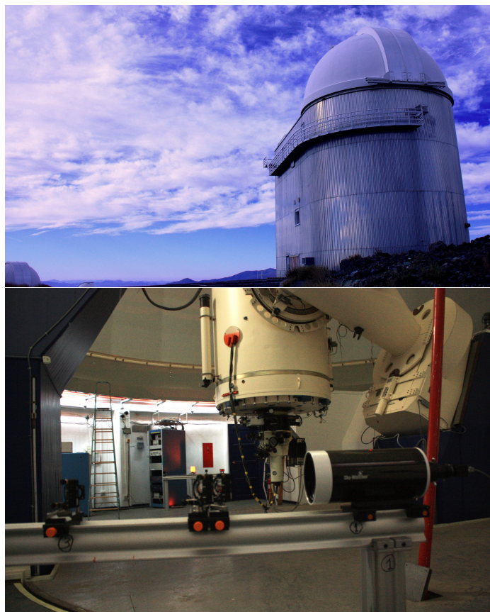
FIGURE 3.33 – Installation et test de LOTUCE à La Silla au Chili en août 2011 à l'intérieur d'une coupole de 10m de hauteur et 10m de diamètre. La coupole abrite un télescope de 1.5m
