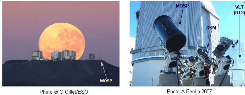
FIGURE 2.1 – Mesures des fluctuations des AA sur le bord lunaire lors de la campagne Paranal 2007 avec le MOSP (photo à droite en premier plan, l'UT3 du VLT apparaît en arrière plan). À gauche, photo du plateau du VLT avec vue de la lune. Le MOSP a été installé à proximité du ESO-DIMM.
