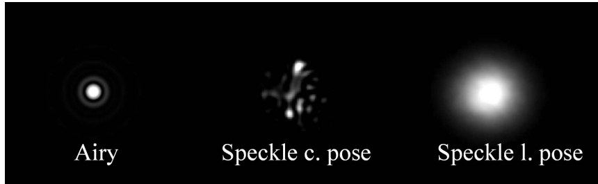
FIGURE 1.3 – À gauche une PSF en absence de turbulence, au milieu une PSF courte pose en présence de turbulence et à droite la PSF longue pose.
