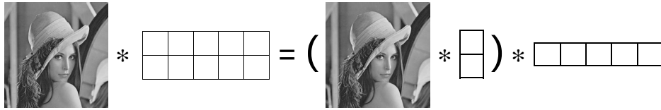
FIGURE 4.2 – Séparation de masque pour une convolution d'image.
