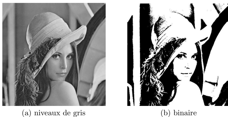
FIGURE A.1 – Exemple d'image en niveaux de gris et binaire (après seuillage).
