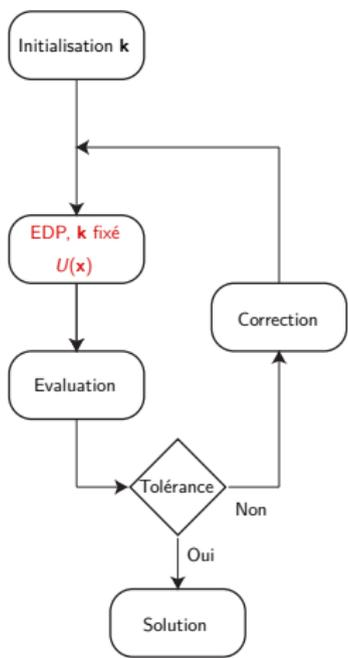
FIGURE : Algorithme classique
