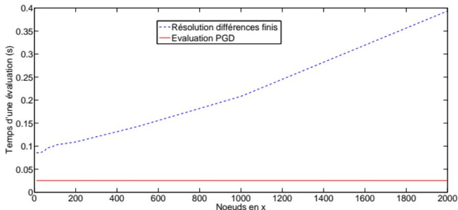
**FIGURE :** Comparaison des temps de calcul entre l'évaluation PGD et différences finies
