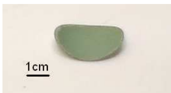
Figure III-1 : Demi cellule cofrittée à 1350°C-3h. Courbure concave côté anode (côté vert).
