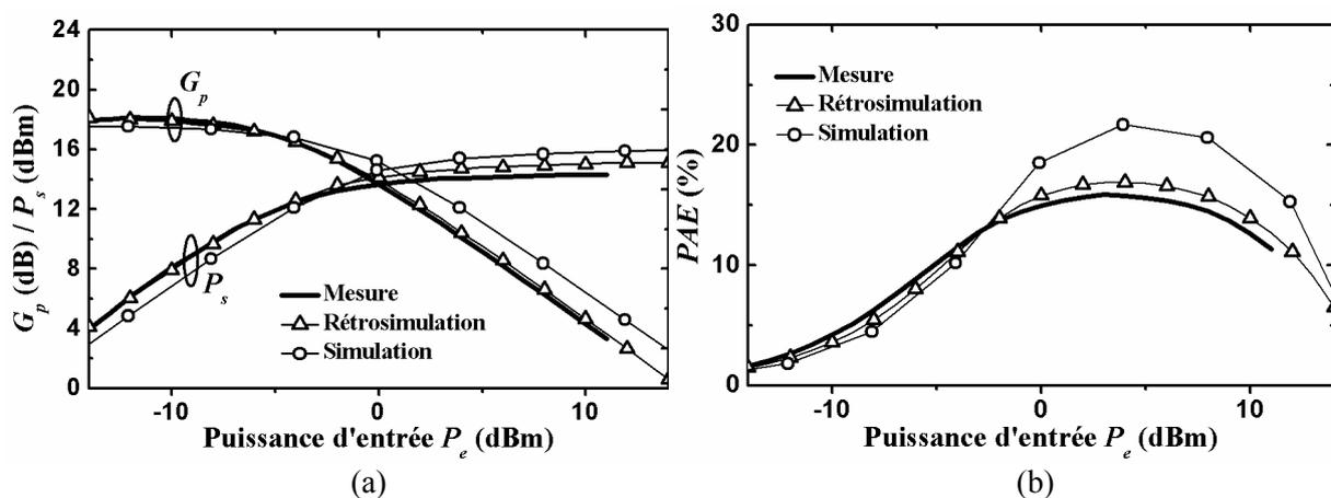
**Figure III-30** : Comparaison des performances en grands signaux de l'amplificateur de puissance à 55 GHz (mesure et rétro-simulation) et à 60 GHz (simulation) en CMOS 65 nm. (a)  $G_p$  et  $P_s$ , (b)  $PAE$ .
