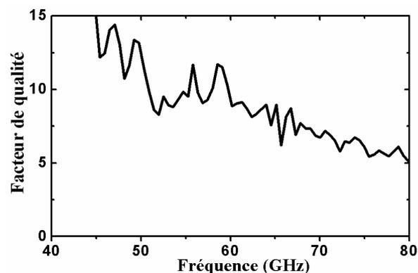
**Figure III-8 : Facteur de qualité mesuré de la capacité MOM de 200 fF en CMOS 45 nm.**
