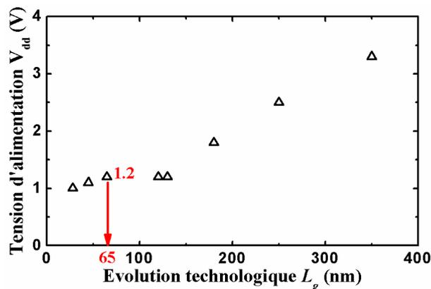
Figure I-12 : Évolution de la tension d'alimentation  $V_{dd}$
