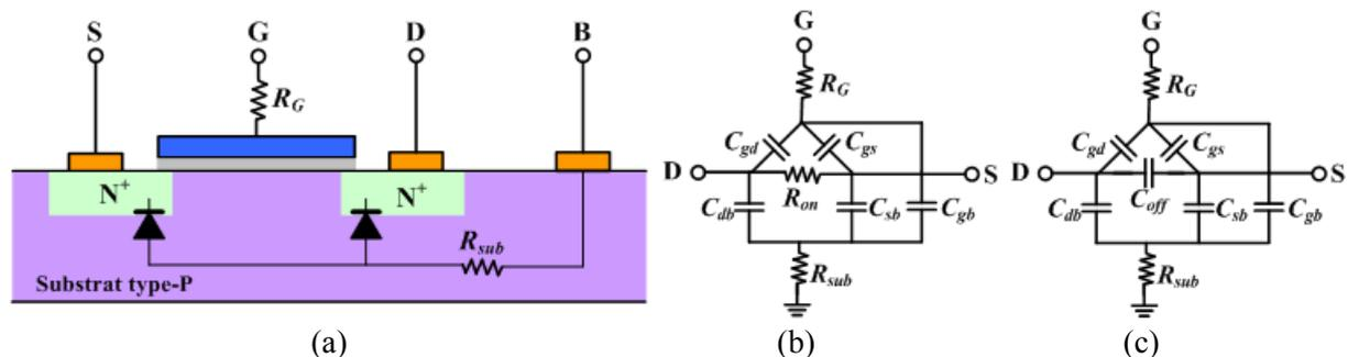
**Figure IV-14 :** (a) Vue en coupe d'un transistor NMOS standard (Bulk), modèle équivalent en petit signal (b) à l'état « ON » [Huang, 01], (c) à l'état « OFF ».
