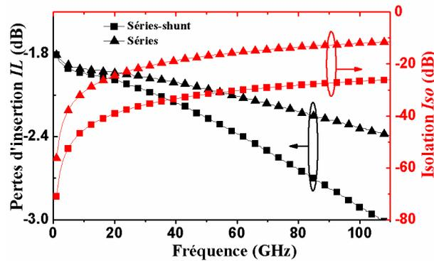
Figure I-25 : Comparaison de la réponse fréquentielle en termes des pertes d'insertion  $IL$  et d'isolation  $Iso$  des topologies en série et en série-shunt ( $W = 20 \mu\text{m}$  et  $L_g = 65 \text{ nm}$ ).
