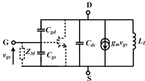
Figure III-19 : Schéma équivalent d'un transistor avec l'effet Miller.
