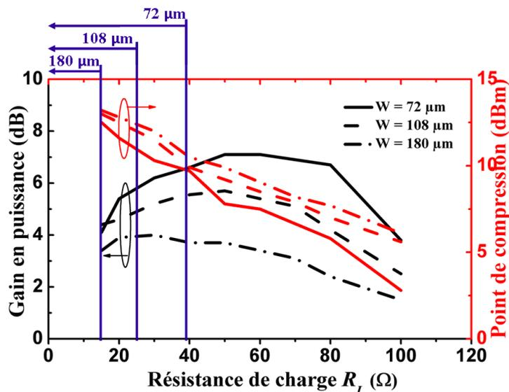
Figure III-17 : Gain en puissance et point de compression en sortie à 60 GHz en fonction des résistances de charge en CMOS 65 nm pour les transistors MOS de largeur  $W = 72 \mu\text{m}$ ,  $108 \mu\text{m}$  et  $180 \mu\text{m}$ . Ces transistors sont polarisés en classe A et adaptés avec les lignes à ondes lentes SCPW9.
