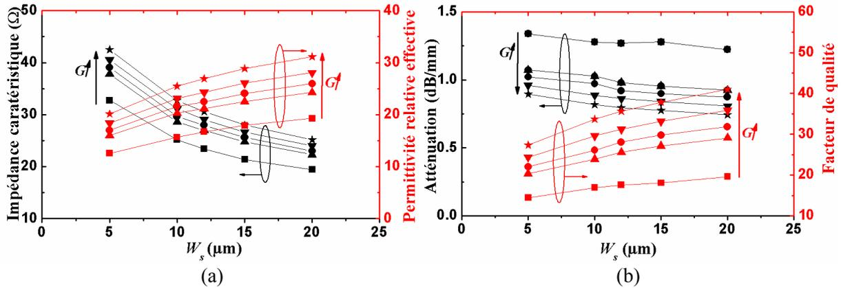
**Figure II-13 : Evolution des paramètres caractéristiques à 60 GHz en fonction des largeurs du ruban central  $W_s$  pour un espacement signal-masse  $G$  donné. (a)  $Z_c$  et  $\epsilon_{\text{effs}}$  (b)  $\alpha$  et  $Q$ . (Lignes S-CPW à topologie classique:  $W_d = W_g = 15 \mu\text{m}$ ,  $h = 0,6 \mu\text{m}$ ,  $SL = 0,1 \mu\text{m}$ ,  $SS = 0,55 \mu\text{m}$ ,  $t_{\text{cpw}} = 2,1 \mu\text{m}$ ,  $t_b = 0,22 \mu\text{m}$ )**
