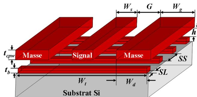
Figure II-1: Schéma d'une ligne S-CPW à topologie classique.
