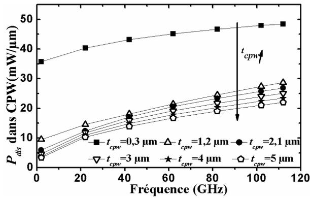
**Figure II-15 : Puissances dissipées dans les conducteurs CPW pour une section périodique de ligne S-CPW par une source d'un ampère. (Lignes S-CPW à topologie classique dont  $t_{cpw}$  varie et  $W_s = 17 \mu\text{m}$ ,  $G = 20 \mu\text{m}$ ,  $W_d = W_g = 15 \mu\text{m}$ ,  $h = 0,6 \mu\text{m}$ ,  $SL = 0,1 \mu\text{m}$ ,  $SS = 0,55 \mu\text{m}$ ,  $t_b = 0,22 \mu\text{m}$ )**
