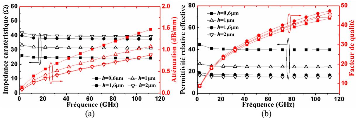
**Figure II-17 : Performances électriques en fonction de la fréquence pour différentes valeurs de l'épaisseur diélectrique. (a)  $Z_c$  et  $\alpha$ , (b)  $\epsilon_{\text{eff}}$  et  $Q$ . (Lignes S-CPW à topologie classique :  $W_s = 17 \mu\text{m}$ ,  $G = 20 \mu\text{m}$ ,  $W_d = W_g = 15 \mu\text{m}$ ,  $SL = 0,1 \mu\text{m}$ ,  $SS = 0,55 \mu\text{m}$ ,  $t_{\text{cpw}} = 2,1 \mu\text{m}$ ,  $t_b = 0,22 \mu\text{m}$ )**
