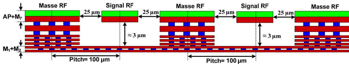
Figure III-12 : Schéma simplifié d'un plot de mesure RF GSGSG utilisé pour la caractérisation des circuits à quatre ports intégrés sur silicium.
