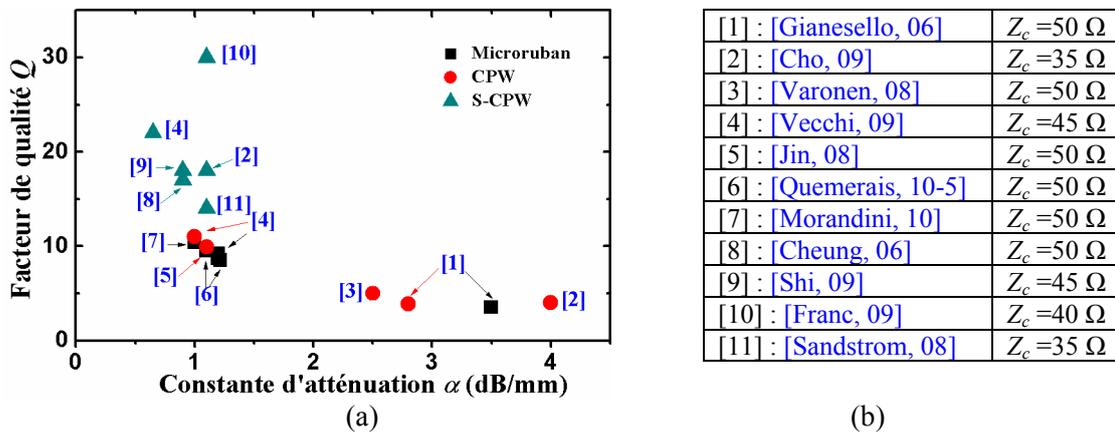
**Figure II-4:** (a) Comparaison du facteur de qualité en fonction de la constante d'atténuation à 60 GHz pour des structures des lignes classiques et S-CPW dans différentes technologies CMOS avancées. (b) tableau récapitulatif des références avec les impédances caractéristiques  $Z_c$  réalisées.
