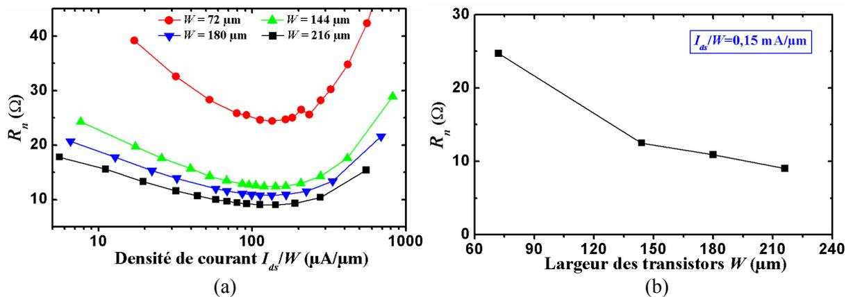
**Figure IV-6 : (a) Résistance équivalente de bruit en fonction de densité de courant pour différentes largeurs de transistor en CMOS 65 nm. (b) Résistance équivalente de bruit en fonction des largeurs de transistor pour la densité de 0,15 mA/ $\mu\text{m}$ .**
