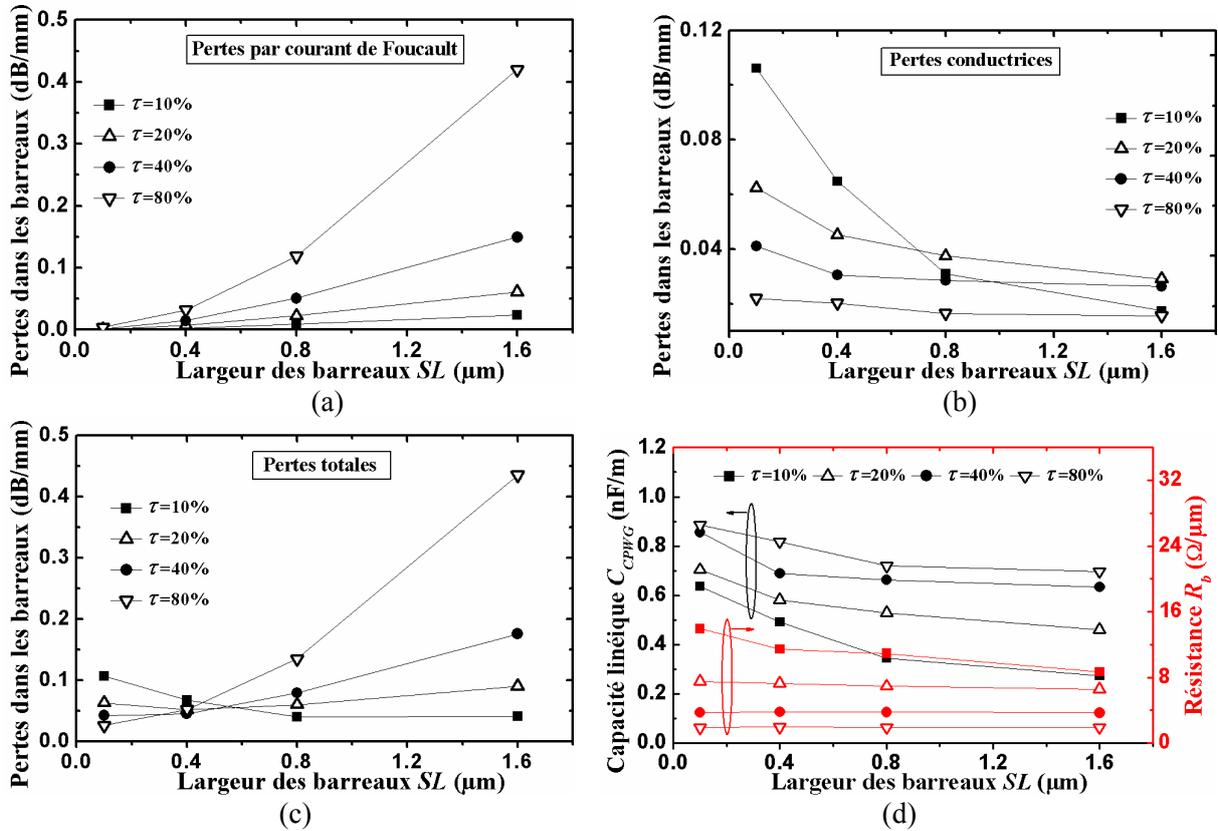
**Figure II-19** : Pertes linéiques à 60 GHz dans les barreaux d'une ligne S-CPW. (a) pertes par courant de Foucault, (b) pertes conductrices, (c) pertes totales. (d) évolution de  $C_{CPWG}$  et  $R_b$  à 60 GHz pour ces lignes. (lignes S-CPW à topologie classique :  $SL$  et  $SS$  varient avec  $W_s = 17 \mu\text{m}$ ,  $G = 20 \mu\text{m}$ ,  $W_d = W_g = 15 \mu\text{m}$ ,  $h = 0,6 \mu\text{m}$ ,  $t_{cpw} = 2,1 \mu\text{m}$ ,  $t_b = 0,22 \mu\text{m}$ )
