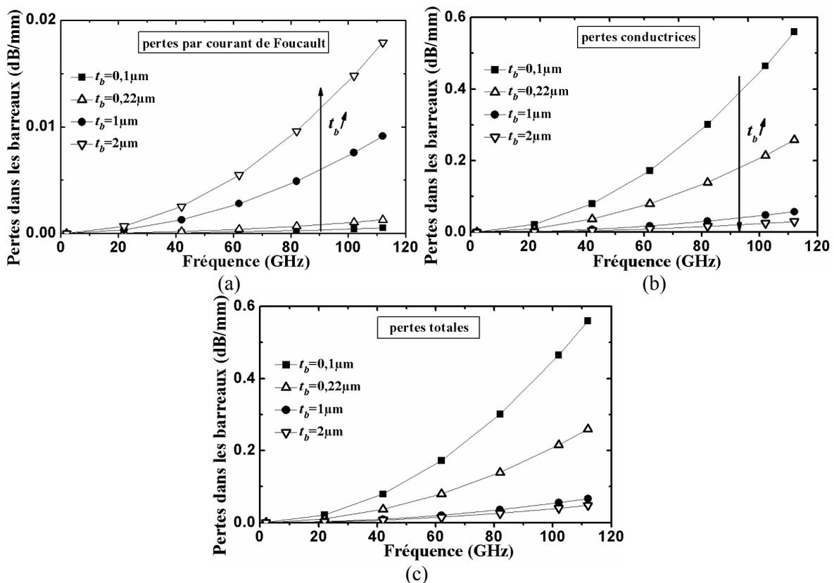
Figure II-20 : Pertes linéiques dans les barreaux d'une ligne S-CPW excitée par une source d'un ampère. (lignes S-CPW à topologie classique :  $t_b$  varie avec  $W_s = 17 \mu\text{m}$ ,  $G = 20 \mu\text{m}$ ,  $W_d = W_g = 15 \mu\text{m}$ ,  $h = 0,6 \mu\text{m}$ ,  $t_{cpw} = 2,1 \mu\text{m}$ ,  $SL = 0,1 \mu\text{m}$ ,  $SS = 0,55 \mu\text{m}$ ).
