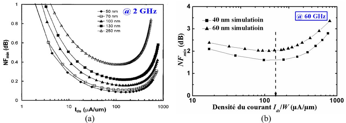
Figure I-8 : Facteur  $NF_{min}$  en fonction de la densité du courant pour différentes technologies. (a) travail dans [Woerlee, 01] à 2 GHz ( $W = 192 \mu m$ ), (b) ce travail à 60 GHz ( $W = 60 \mu m$ ).
