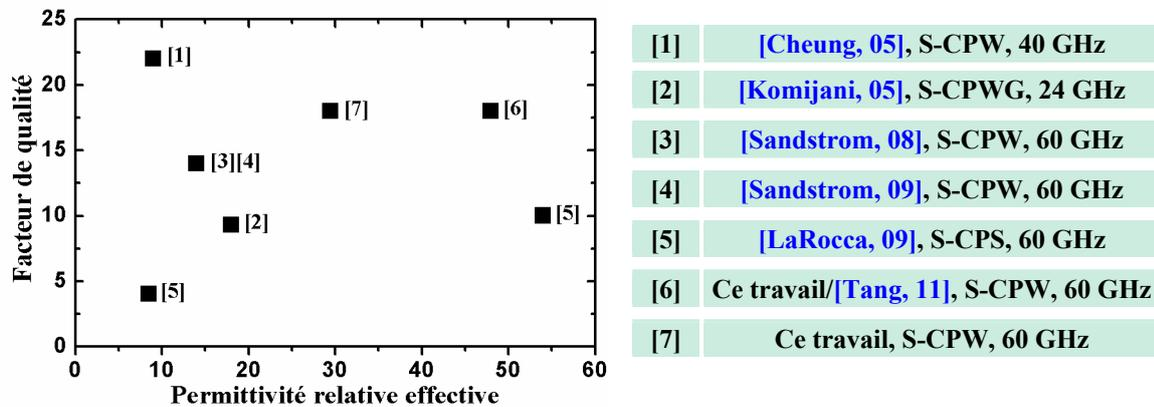
Figure III-5 : Comparaison des performances électriques ( $\epsilon_{\text{eff}}$  et  $Q$ ) à la fréquence correspondante des lignes à ondes lentes utilisées dans les amplificateurs de puissance issus de la littérature.
