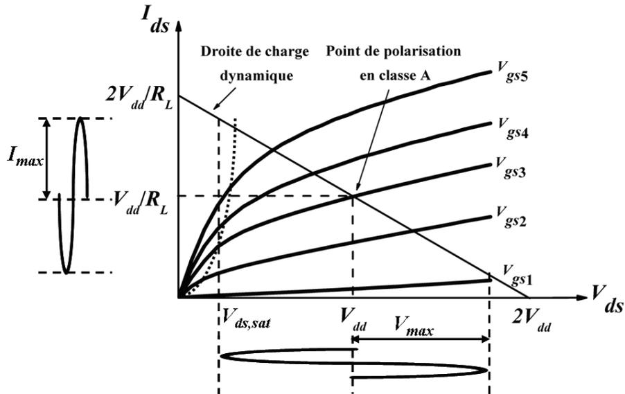
Figure III-13 : Droite de charge dynamique d'un transistor MOS.
