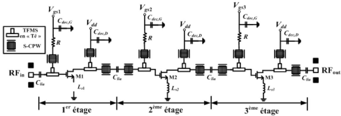
Figure III-22 : Schéma de l'amplificateur de puissance à 60 GHz cascadié à trois étages fonctionnant en classe A en technologie CMOS 65 nm.
