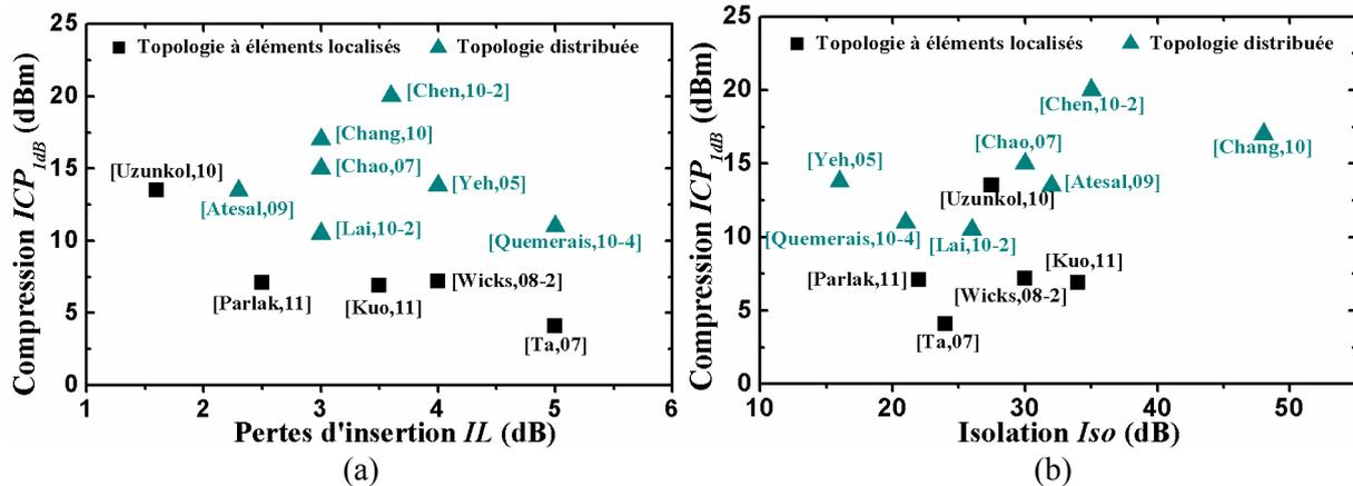
Figure I-27 : Comparaison des performances de SPDT de l'état de l'art fonctionnant à 60 GHz en topologie à éléments localisés et distribuée en technologies CMOS. (a)  $IL$  et  $ICP_{1dB}$ , (b)  $Iso$  et  $ICP_{1dB}$ .
