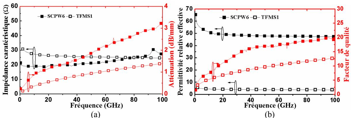
Figure II-21 : Comparaison des performances mesurées des lignes S-CPW avec les lignes TFMS en technologie CMOS 45 nm sur (a)  $Z_c$  et  $\alpha$ , (b)  $\epsilon_{eff}$  et  $Q$ .
