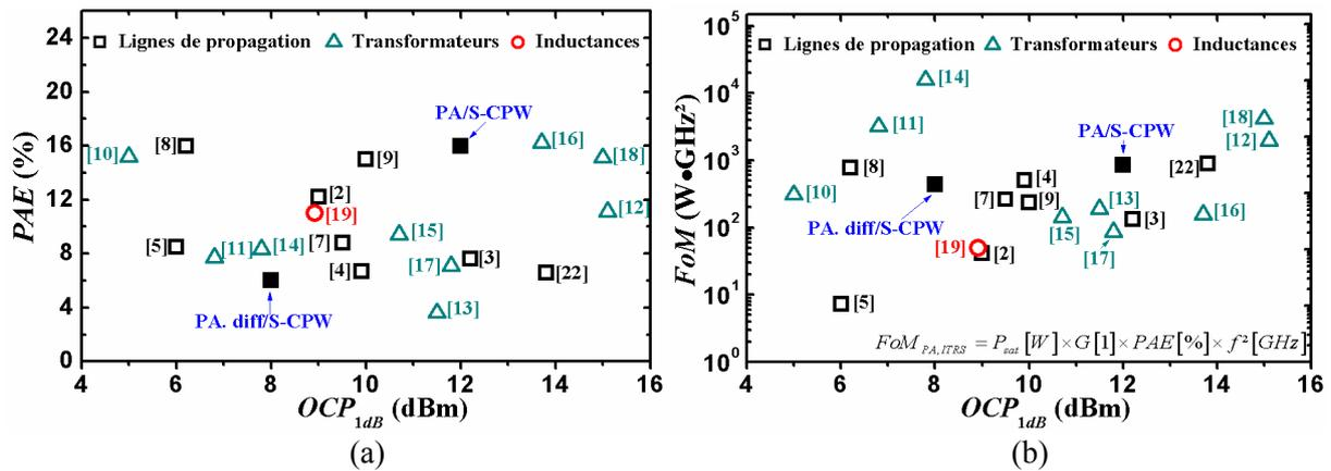
Figure III-38 : Comparaison des performances des amplificateurs de puissance travaillant autour de 60 GHz en technologie CMOS 65 nm dans la littérature avec les PAs réalisés dans ce mémoire. (a)  $PAE$  et  $OCP_{1dB}$ , (b)  $FoM$  et  $OCP_{1dB}$ .
