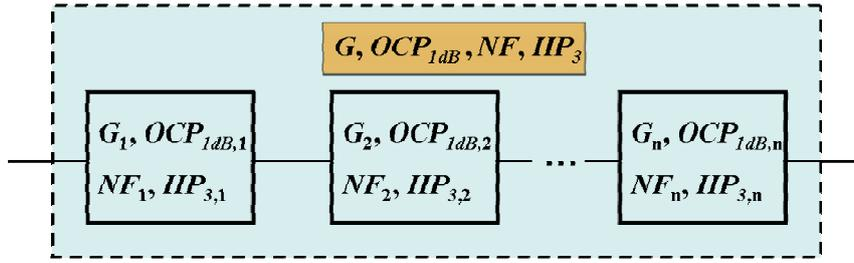
Figure. A-3.2 : Schéma d'une chaîne cascadiée à n étages
