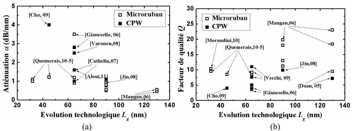
Figure I-15 : État de l'art à 60 GHz (a) des constantes d'atténuation, (b) des facteurs de qualités, pour les lignes de propagation classiques (microruban et CPW) à 50  $\Omega$  en fonction de l'évolution technologique.
