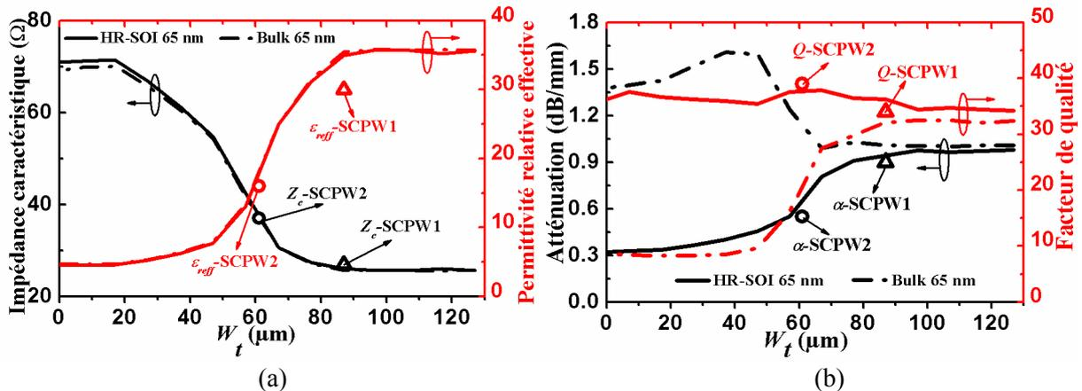
Figure II-9 : Performances simulées à  $60 \text{ GHz}$  en technologie CMOS Bulk et HR-SOI  $65 \text{ nm}$  pour les lignes S-CPW dont la longueur des barreaux varie et performances mesurées en HR-SOI de lignes SCPW1 et SCPW2. (a)  $Z_c$  et  $\epsilon_{\text{reff}}$ , (b)  $\alpha$  et  $Q$ .
