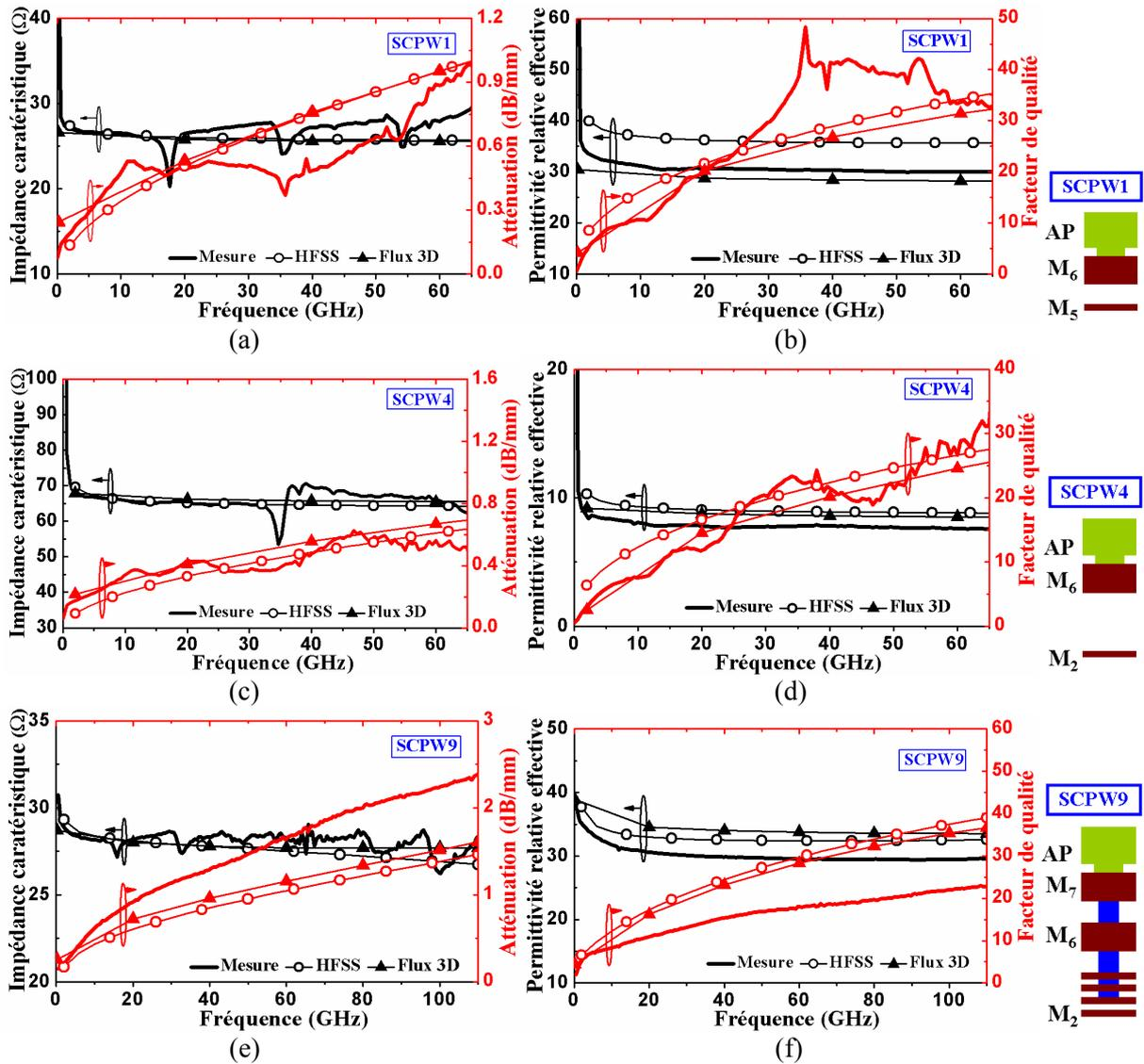
Figure II-7 : Comparaison des résultats de mesure, de simulation par logiciel HFSS et Flux 3D pour les lignes SCPW1 et SCPW9. (a)  $Z_c$  et  $\alpha$  de SCPW1, (b)  $\epsilon_{eff}$  et  $Q$  de SCPW1, (c)  $Z_c$  et  $\alpha$  de SCPW4, (d)  $\epsilon_{eff}$  et  $Q$  de SCPW4, (e)  $Z_c$  et  $\alpha$  de SCPW9, (f)  $\epsilon_{eff}$  et  $Q$  de SCPW9.
