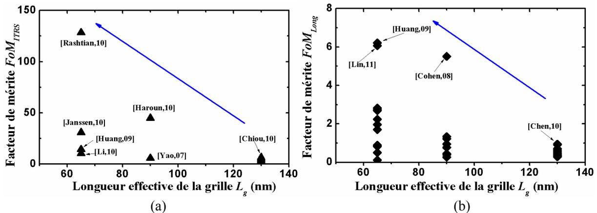
Figure I-22 : Evolution des facteurs de mérite des LNAs à 60 GHz en fonction de la longueur de la grille. (a)  $FoM_{ITRS}$ , (b)  $FoM_{Long}$ .
