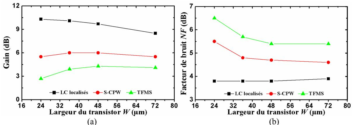
**Figure IV-8 : Comparaison des performances simulées à 60 GHz d'un étage cascode adapté à  $Y_{opt}$  en entrée et à 50  $\Omega$  en sortie respectivement aux éléments localisés parfaits, à lignes S-CPW et à lignes TFMS. (a) Gain, (b) facteur de bruit  $NF$ .**
