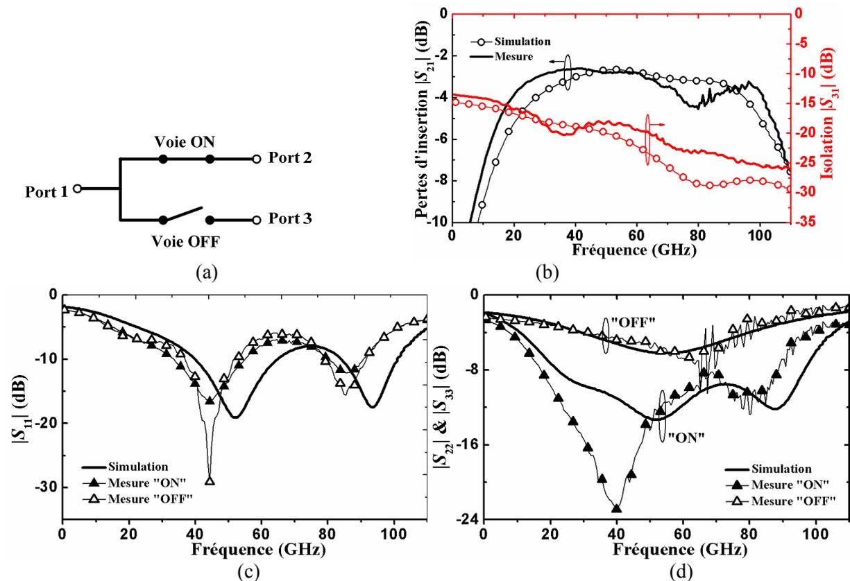
**Figure IV-25 :** (a) Schéma représentatif de caractérisation et les performances mesurées et simulées du SPDT à lignes S-CPW réalisé en CMOS 65 nm avec  $V_b = -2$  V et  $V_{dsw} = 1,4$  V. (b)  $IL$  et  $Iso$ , (c)  $|S_{11}|$  à l'état « ON » et « OFF », (d)  $|S_{22}|$  et  $|S_{33}|$  à l'état « ON » et « OFF ».
