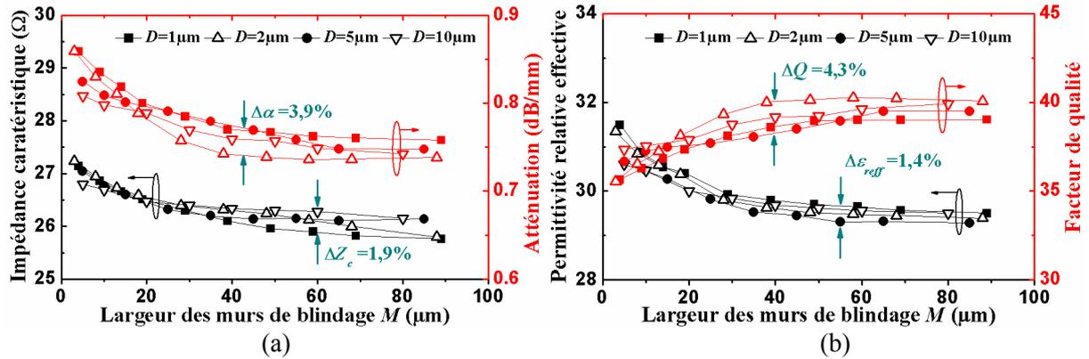
Figure II-16 : Evolution des paramètres caractéristiques à 60 GHz en fonction des largeurs des murs de blindage pour S-CPW blindées dont le paramètre  $D$  varie. (a)  $Z_c$  et  $\alpha$ , (b)  $\epsilon_{\text{eff}}$  et  $Q$ . ( $W_s = 17 \mu\text{m}$ ,  $G = 20 \mu\text{m}$ ,  $W_a = 15 \mu\text{m}$ ,  $h = 0,6 \mu\text{m}$ ,  $SL = 0,1 \mu\text{m}$ ,  $SS = 0,55 \mu\text{m}$ ,  $t_{\text{cpw}} = 2,1 \mu\text{m}$ ,  $t_b = 0,22 \mu\text{m}$ )
