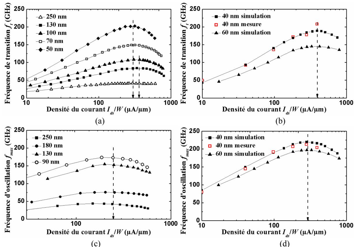
Figure I-6 : Fréquences  $f_t$  et  $f_{max}$  en fonction de la densité du courant pour différentes technologies. (a)  $f_t$  : travail dans [Woerlee, 01], (b)  $f_t$  : ce travail, (c)  $f_{max}$  : travail dans [Dickson, 06], (d)  $f_{max}$  : ce travail
