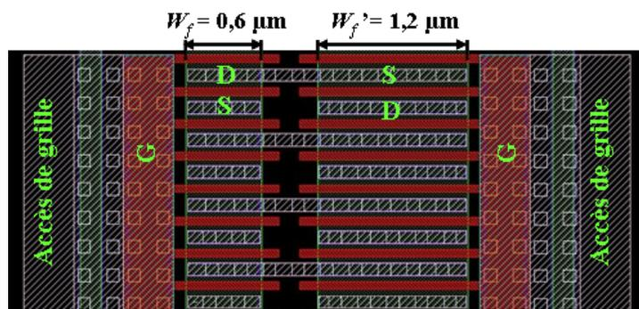
Figure IV-5 : Exemple du dessin d'un transistor en topologie cascode.
