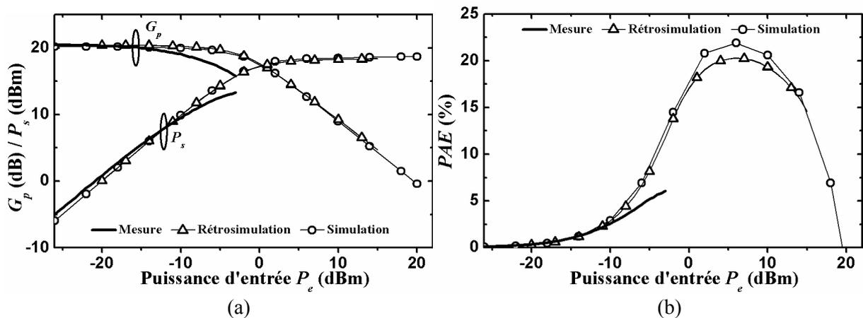
**Figure III-37 : Comparaison des performances en grands signaux de l'amplificateur PA diff. /S-CPW à 55 GHz (mesure et rétro-simulation) et à 60 GHz (simulation) en CMOS 65 nm. (a)  $G_p$  et  $P_s$ , (b) PAE.**
