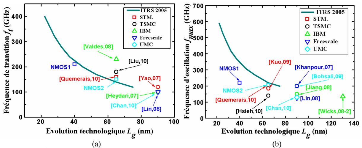
Figure I-5 : Évolution en fonction des nœuds technologiques de (a)  $f_i$ , (b)  $f_{max}$  pour une densité de courant de l'ordre de 0,3 à 0,4 mA/μm. NMOS1 et NMOS2 correspondent à deux transistors utilisés dans ce manuscrit et présentant une densité de courant de 0,35 mA/μm, respectivement en technologie CMOS 45 nm et en 65 nm STMicroelectronics.
