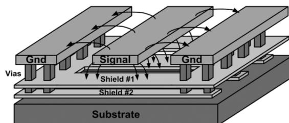
Figure III-2 : Schéma d'une ligne S-CPWG de [Komijani, 05].
