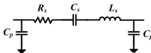
**Figure III-6 : Modèle électrique de la capacité MOM.**
