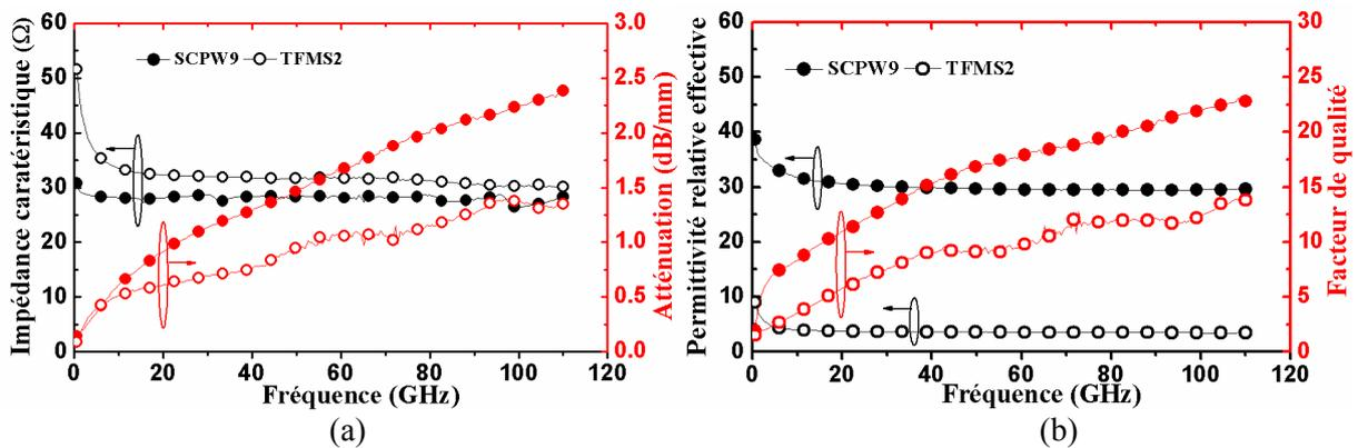
**Figure III-25: Comparaison des performances mesurées des lignes S-CPW avec les lignes TFMS utilisées dans la conception des PAs en technologie CMOS 65 nm sur (a)  $Z_c$  et  $\alpha$ , (b)  $\epsilon_{eff}$  et  $Q$ .**
