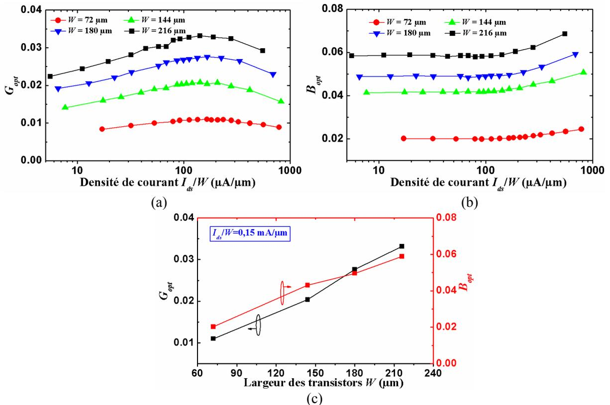
**Figure IV-7 : Admittance optimale en fonction de la densité de courant pour différentes largeurs de transistor en CMOS 65 nm. (a)  $G_{opt}$ . (b)  $B_{opt}$ . (c)  $G_{opt}$  et  $B_{opt}$  en fonction des largeurs de transistor pour la densité du courant de 0,15 mA/ $\mu$ m.**
