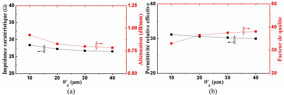
**Figure II-14 :** (a)  $Z_c$  et  $\alpha$ , (b)  $\epsilon_{reff}$  et  $Q$  à 60 GHz en fonction de la largeur des plans de masse. (Lignes à topologie classique :  $W_s = 17 \mu\text{m}$ ,  $G = 20 \mu\text{m}$ ,  $W_d = 15 \mu\text{m}$ ,  $h = 0,6 \mu\text{m}$ ,  $SL = 0,1 \mu\text{m}$ ,  $SS = 0,55 \mu\text{m}$ ,  $t_{cpw} = 2,1 \mu\text{m}$ ,  $t_b = 0,22 \mu\text{m}$ )
