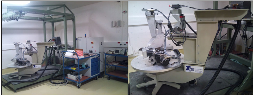
FIGURE II.17 – photographie du diffractomètre du laboratoire LVA/CNDRI de l'INSA de Lyon.
