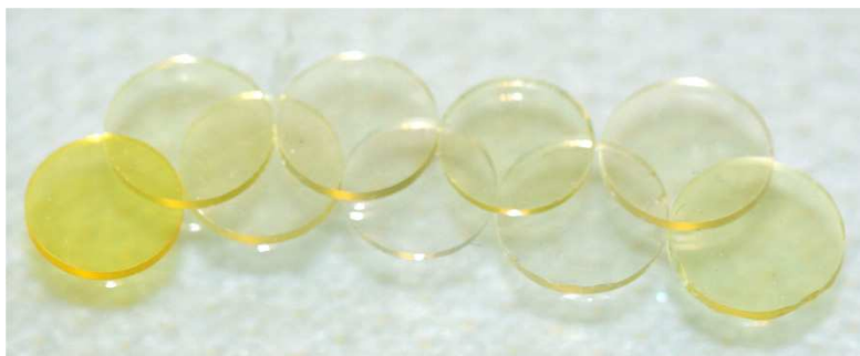
Figure 41 : Matériaux dopés PE2 polis. Les concentrations vont de 400mM (le plus coloré) à 0,1mM (incolore).
