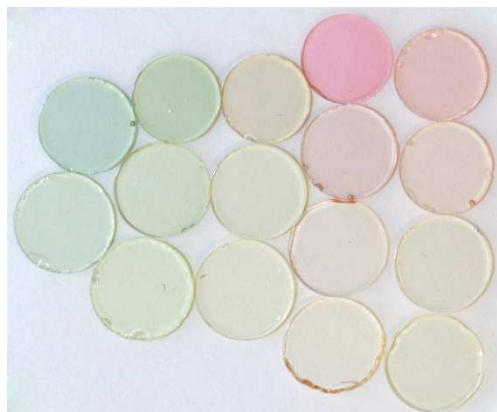
Figure 115 : Matériaux dopés avec du PE2 et des particules d'or bipyramidales (les huit premiers à gauche) et sphériques (à droite).
