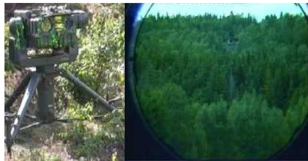
Figure 60 : Résultats en limitation obtenus pour les matériaux dopés PE2 400mM et PE3 100mM (à droite) et dispositif utilisé pour les tests en conditions réelles. Source : FOI.
