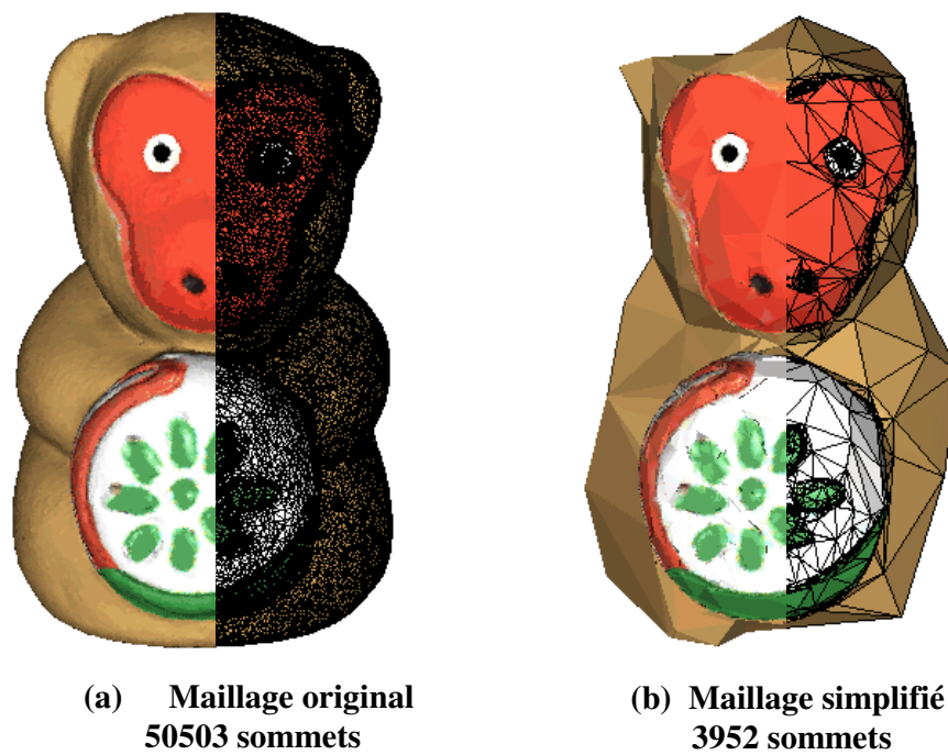
FIGURE 3.8 – Le maillage original du modèle "GIST-Monkey" (à gauche) et le maillage simplifié du même modèle (à droite) en utilisant notre métrique basée sur l'erreur de la couleur E_C uniquement. On constate que la couleur est bien préservée, mais la géométrie n'est pas conservée correctement.
