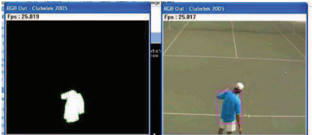
Figure 6 : Visualisation du traitement de l'image par RTVAL (système HSV : écran de gauche)
