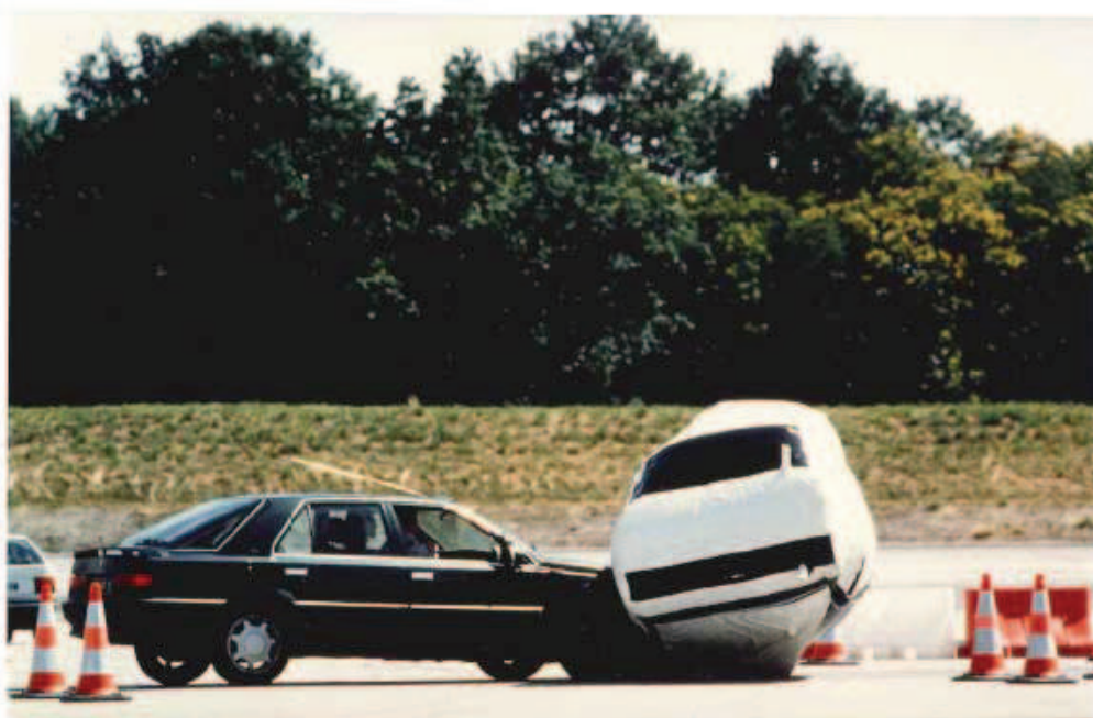
Figure 32 : exemple de mauvaise manœuvre : le conducteur de la voiture d'essais a peu freiné et n'a pas essayé d'éviter l'obstacle.
