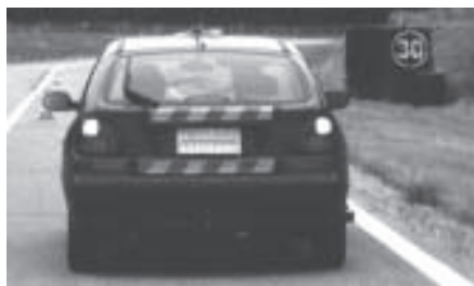
Figure 36 : Exemple d'instruction de décélération. Compte tenu de la vitesse actuelle, la vitesse de consigne est affichée sur le panneau placé sur le bas côté de la piste.
