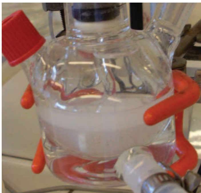
Figure B.4- Apparition du film huileux en surface après explosion des gouttes de l'émulsion
