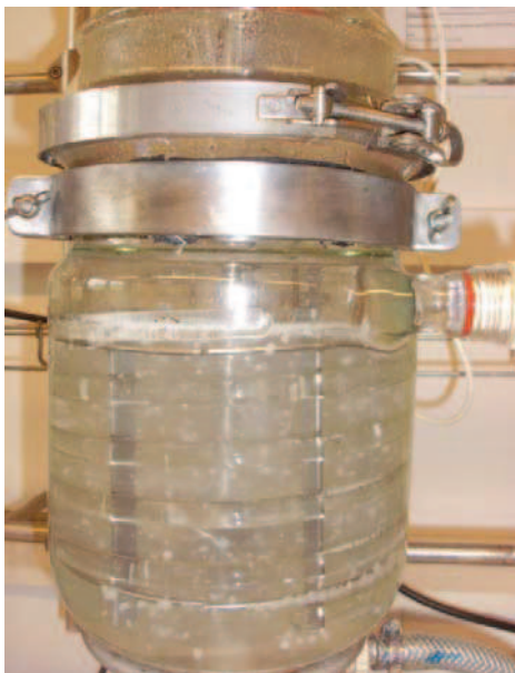
Figure 4.14- Suspension des particules d'EGDS à 58^{\circ}\text{C} (essai AK74)
