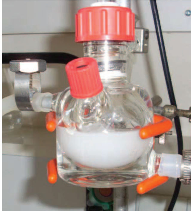
Figure B.2- L'émulsion d'EGDS dans l'eau à 70°C sous agitation
