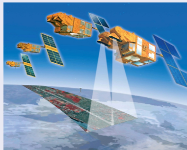
(b) L'instrument HRG : deux capteurs multi-spectraux avec possibilité de fusion (Supermode)
