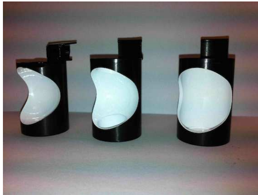
FIGURE 2.21 – Exemple de miroirs pour la scintillation liquide (Triathler) [Hidex b].
