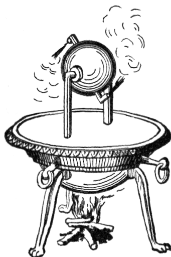
FIGURE 1.2 – L'Eolipyle d'Héron d'Alexandrie
