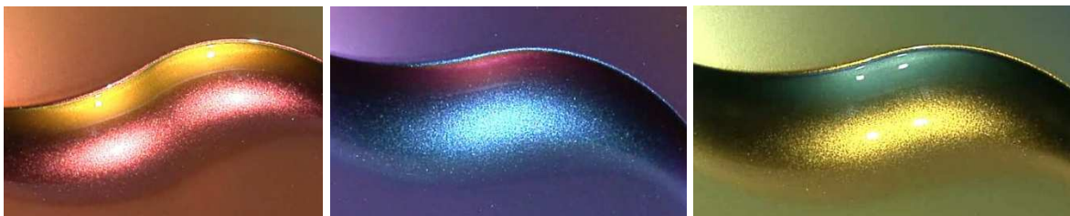
Figure 2.32. Peinture à pigments ChromaFlair appliquée sur une surface courbée. De gauche à droite : RedGold000, CyanPurple230, SilverGreen060.
