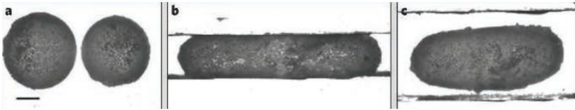
**Figure II-9 : a) Deux bulles de gaz stabilisées par une couche dense de particules de polystyrène b) Compression des bulles de gaz entre deux lames de verres et coalescence c) Morphologie ellipsoïdale maintenue stable même après avoir retiré les lames de verre <sup>[59]</sup>.**
