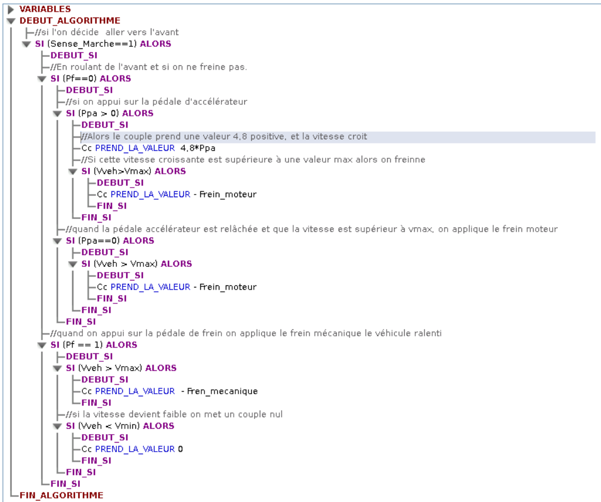
Figure 4.27 : Algorithme pour élaborer la consigne de couple en marche Avant.
