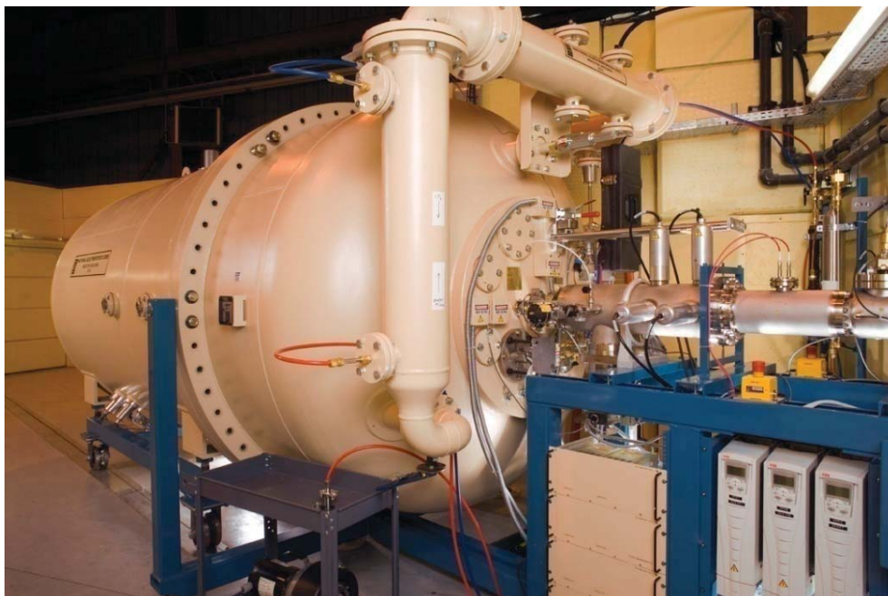
Figure 2.14 Photo de l'accélérateur Epiméthée [Trocellier]
