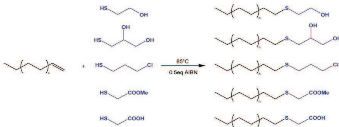
Fig. 1-29. Réactions de thiol-ène entre le PE-vinyle et des thiols fonctionnels pour introduire des groupes réactifs.
