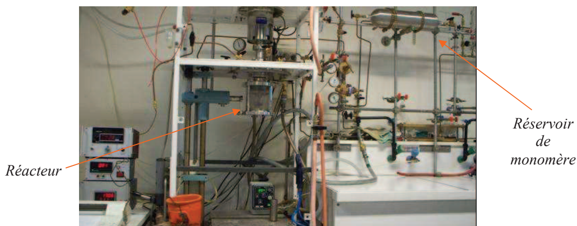
Fig. 2-4. Réacteur en verre de 500 mL avec un réservoir de monomère de 2,3 litres.
