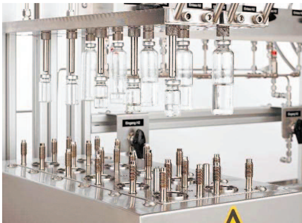
Fig. 2-11. Image du multi-réacteur haute pression (1-40 bars) utilisé.
