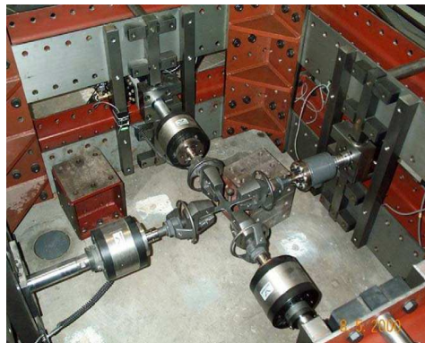
Figure 2.2. Dispositif d'essais biaxiaux Smits et al., 2006
