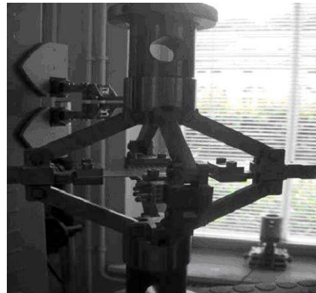
Figure 2.4. Dispositif d'essais biaxiaux Ferron, G., Makinde, A., 1988. a- Schéma du dispositif de traction biaxiale. b- Photo du dispositif en place sur la machine de traction.
