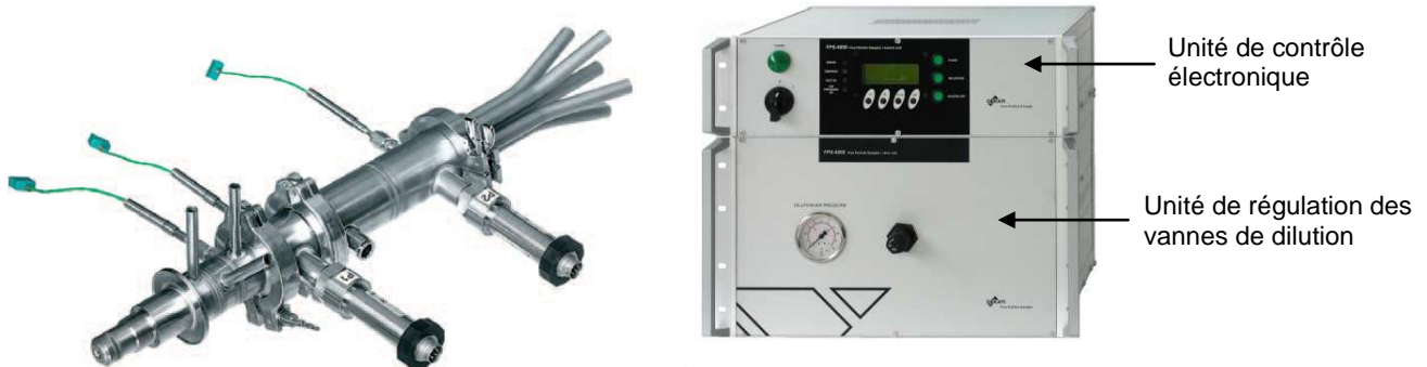
Figure II-8 : La sonde de dilution, l'unité de contrôle électronique et l'unité de régulation des vannes de dilution.
