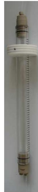
(b) Cellule d'écoulement à double injection.
