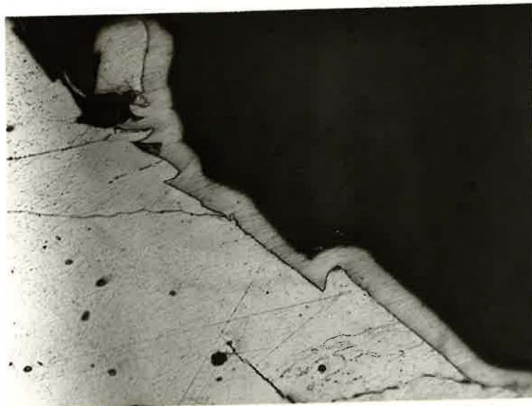
Figure 9 - Clivage intracristallin dans un acier à 4,5 % Si Température d'essai : + 20°C Attaque Nital 10 % G = 300
