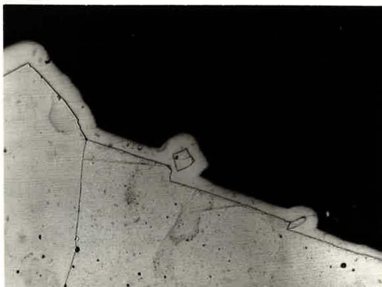
Figure 46 - Rupture par clivage intracristallin dans un acier décarburé. Acier à 2,05 % Si et 30 ppm C. Température de l'essai : 20°C. Attaque Nital 10 % G = 140.
