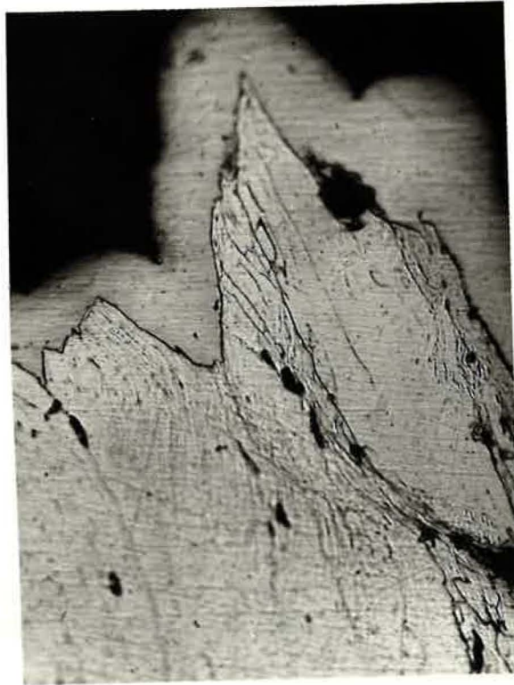
Figure 11 - Décohésion "intergranulaire ductile" dans un acier à 4,5 % Si, Même éprouvette que figure 10. Autre région de la cassure. Attaque Nital 10 % G = 400
