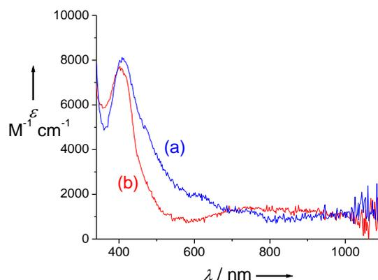
Figure 157: Spectres UV-Vis de solutions à 0.05 mM dans  $\text{CH}_2\text{Cl}_2$  des dications générés par électrochimie (+0.01 M TBAP): a)  $[\text{Co}(\text{1}^{\text{OMe}})]^{2+}$  (rouge); b)  $[\text{Co}(\text{1}^{\text{tBu}})]^{2+}$  (bleu).  $T = 240 \text{ K}$ .
