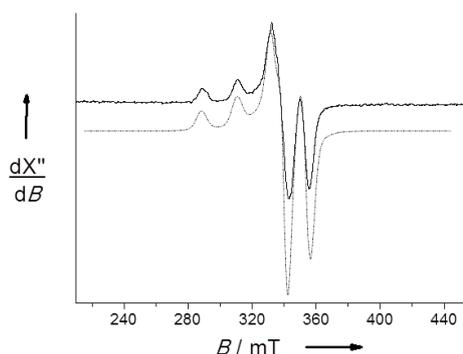
Figure 88 : Spectres RPE en bande X d'une solution à 0.5 mM dans  $\text{CH}_2\text{Cl}_2$  anhydre de  $[\text{Cu}(1\text{N}_4^{\text{tBu}})]$  à 12 K. Le spectre en pointillés représente la simulation du spectre en utilisant les paramètres  $g_1 = 2.292$ ,  $g_2 = 2.03$  et  $g_3 = 1.96$ .
