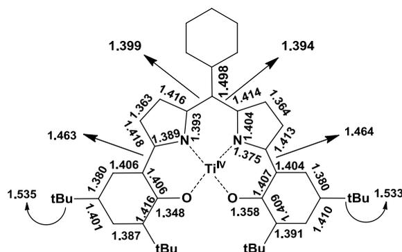
Figure 128: Analyse des longueurs de liaison dans le complexe [Ti<sup>IV</sup>(10)(Cl)(THF)] (avec une erreur de  $\pm 0.01$  Å). Cette représentation omet la coordination des ligands axiaux.
