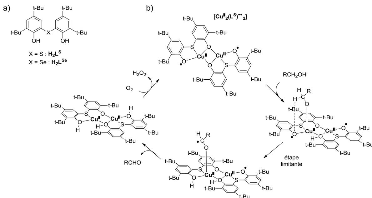
Figure 196 : a) ligands  $H_2L^S$  et  $H_2L^{Se}$  et b) mécanisme proposé pour l'oxydation catalytique d'alcools primaires et secondaires par  $[Cu^{II}_2(L^S)^{2+}]$ .
