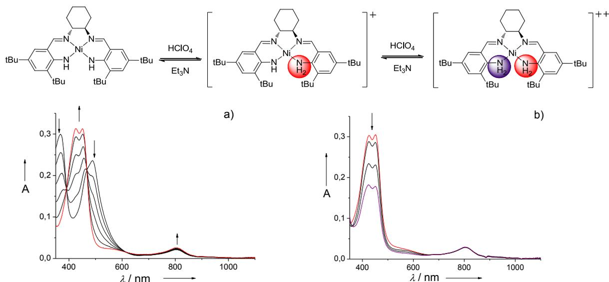
Figure 87: Titrage du complexe neutre  $[\text{Ni}(1\text{N}_4^{\text{tBu}})]$  (0.05 mM dans  $\text{CH}_2\text{Cl}_2$ ) par une solution de  $\text{HClO}_4$  (0.005 M dans  $\text{CH}_3\text{CN}$ ) a) de 0 à 1 équivalent et b) de 1 à 2 équivalents de  $\text{HClO}_4$ . Trajet optique 1.000 cm T = 298K. Les flèches indiquent l'évolution du spectre lors de l'ajout d'acide.
