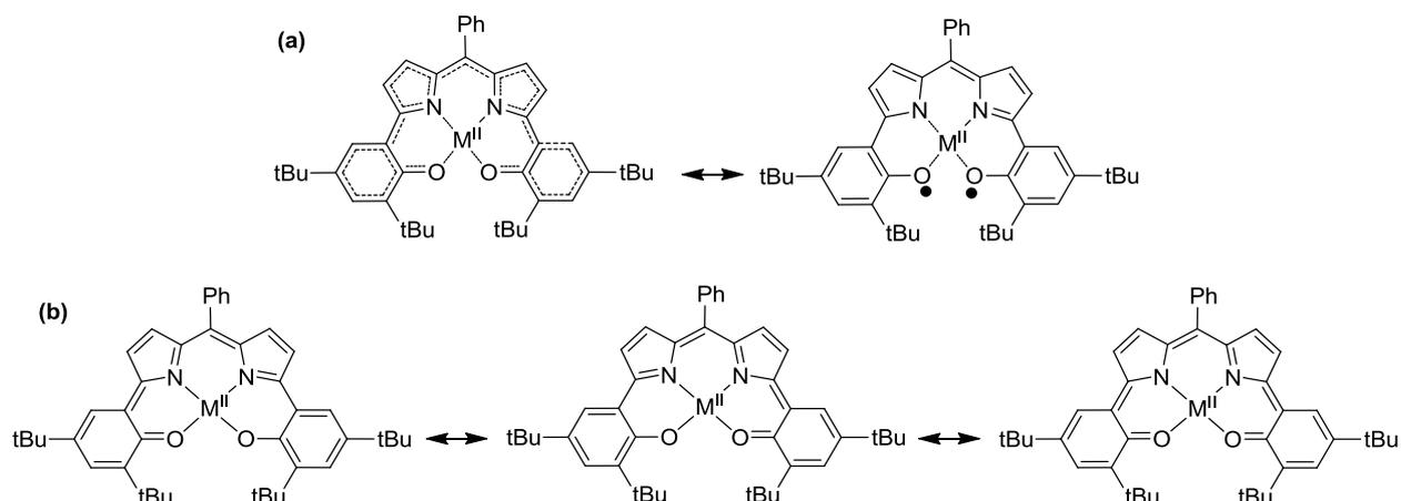
Figure 134: Représentation des différentes formulations possibles du complexe dioxydé sur le ligand: a) ligand diradicalaire  $[\text{Ni}(10)^{\bullet\bullet}]^+$  et b) système à couche fermée  $[\text{Ni}(10)^{\text{ox}}]^+$ .
