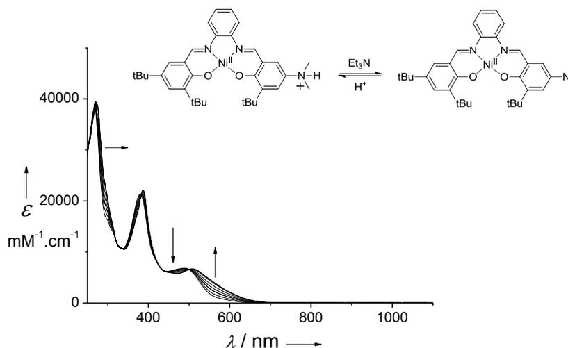
Figure 70: Titrage de  $[\text{Ni}(3\text{H})]^+$  (0.05 mM dans  $\text{CH}_2\text{Cl}_2$ ) par 0 à 1 équivalent molaire de  $\text{Et}_3\text{N}$  (2.5 mM). Les flèches indiquent les changements du spectre lors de l'ajout de  $\text{Et}_3\text{N}$ . T = 298 K, l = 1.000 cm.
