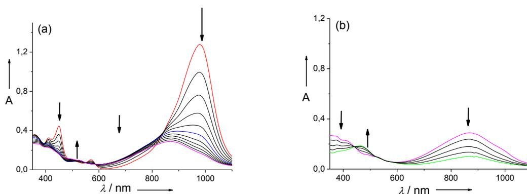
**Figure 177:** Titrage du complexe monooxydé  $[\text{Co}(\text{1}_{\text{N}_4}^{\text{tBu}})]^+.\text{SbF}_6^-$  (ligne rouge) a) de 0 jusqu'à 1 (ligne bleu) puis 2 équivalents de *N*-méthylimidazole puis b) jusqu'à 7.2 équivalents (ligne verte). Les flèches indiquent l'évolution du spectre au cours des ajouts. Trajet optique = 1.000 cm. T = 298 K.
