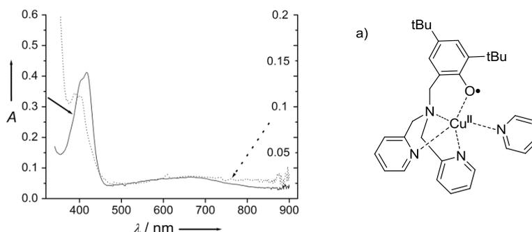
**Figure 11:** Spectre UV-vis de: ligne pleine : complexe (a) représenté dans cette figure (0.11 mM dans l'acétonitrile). Ligne en pointillé: radical du ligand libre (0.24 mM dans le dichlorométhane). L'absorbance est sous estimée dans la dernière espèce qui est instable.
