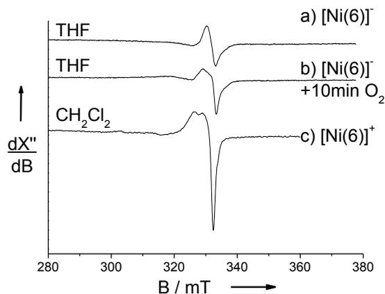
Figure 107: Spectres RPE en bande X de solutions à 0.5 mM: a) complexe réduit  $[\text{Ni}(\text{ATSM})]^-$  généré par réduction chimique, b)  $[\text{Ni}(\text{ATSM})]^-$  exposé 10 min à l'air et c)  $[\text{Ni}(\text{ATSM})]^{+\cdot}$  généré par électrochimie.  $T = 100 \text{ K}$  dans a) et b) le THF anhydre ou c) dans  $\text{CH}_2\text{Cl}_2$  (+0.1 M TBAP).
