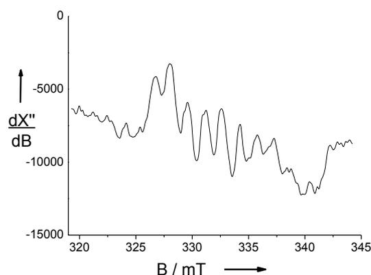
Figure 180: Spectre RPE en bande X d'une solution à 0.5 mM dans  $\text{CH}_2\text{Cl}_2$  (+0.1 M TBAP) du dication  $[\text{Co}(\text{1}_{\text{N}_4}^{\text{tBu}})]^{2+}$  généré par électrochimie. T = 220 K.
