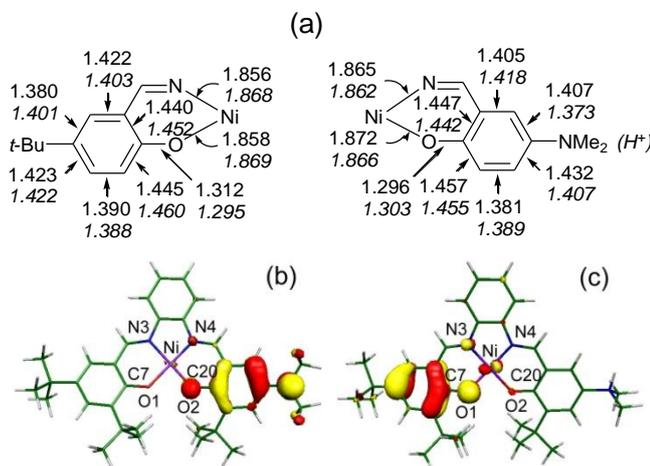
Figure 75: (a) Longueurs de liaison (en Å) dans les cycles phénolate/phénoxyde de  $[\text{Ni}(3')]^+$  (texte normal) et  $[\text{Ni}(3\text{H})]^{2+}$  (texte en italique) obtenues par optimisation de géométrie (pour plus de clarté seul le substituant en para est représenté) et localisation de la SOMO de  $[\text{Ni}(3')]^+$  (b) et  $[\text{Ni}(3\text{H})]^{2+}$  (c).
