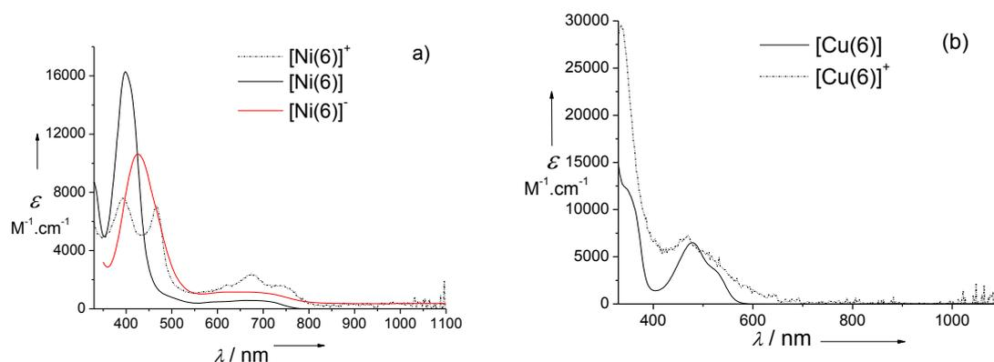
Figure 104: Spectres électroniques de solutions à 0.05 mM des complexes a) [Ni(6)] (ligne noire), [Ni(6)]<sup>+</sup> (ligne en pointillés) et [Ni(6)]<sup>-</sup> (ligne rouge) et b) [Cu(6)] (lignes noires), [Cu(6)]<sup>+</sup> (lignes en pointillés). Espèces monoxydées
