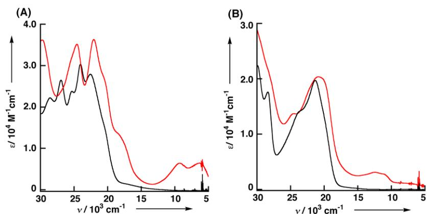
Figure 63: Spectres électroniques des complexes neutres (lignes noires) et monoxydés générés par oxydation chimique (lignes rouges): (A)  $[\text{Cu}(\text{OMe})_2]$  et  $[\text{Cu}(\text{OMe})_2]^+$ , (B)  $[\text{Cu}(2\text{OMe})]$  et  $[\text{Cu}(2\text{OMe})]^+$
