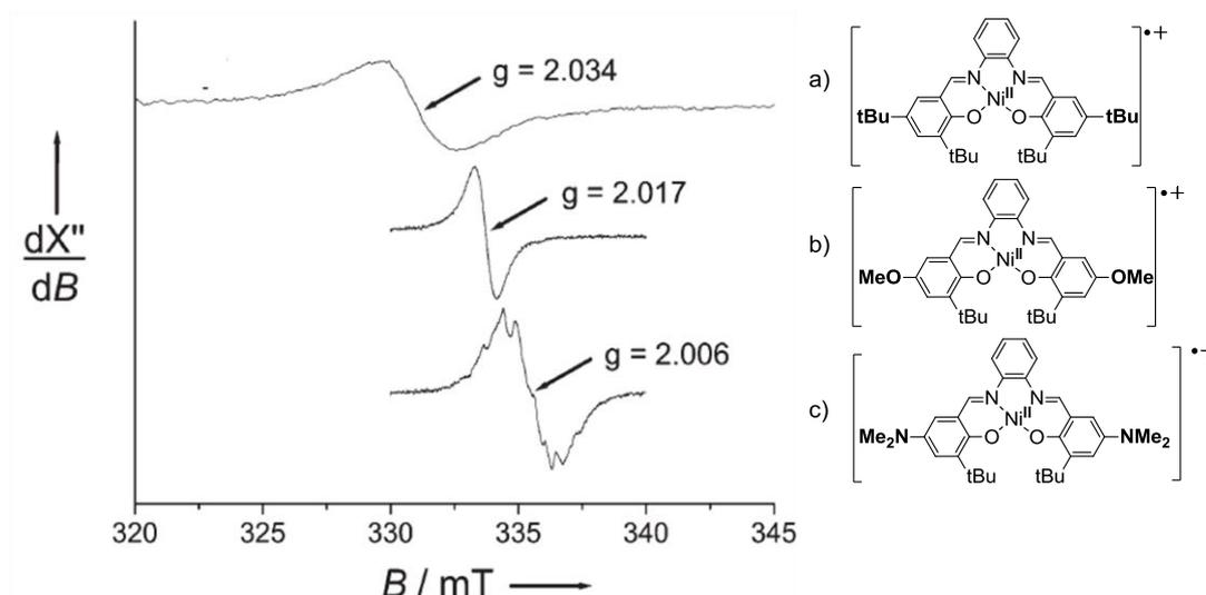
Figure 42: Spectres RPE en bande X de solutions à 1 mM dans le dichlorométhane de : (a)  $[\text{Ni}^{\text{II}}(2^{\text{tBu}})]^{\bullet+}$ ; (b)  $[\text{Ni}^{\text{II}}(2^{\text{OMe}})]^{\bullet+}$  et  $[\text{Ni}^{\text{II}}(2^{\text{NMe}})]^{\bullet+}$ .<sup>121</sup>
