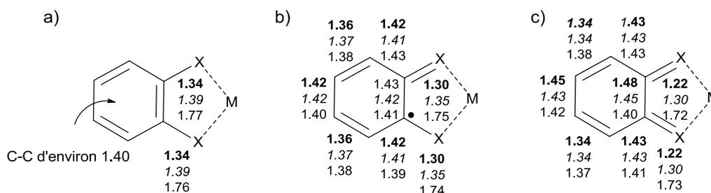
Figure 19: Longueurs de liaison (en Å) pour les trois degrés d'oxydation des fragments (texte en gras : X = O<sup>63,6466</sup>, en italique : X = N<sup>65</sup>, normal X = S<sup>66,67</sup>) coordonnés.
