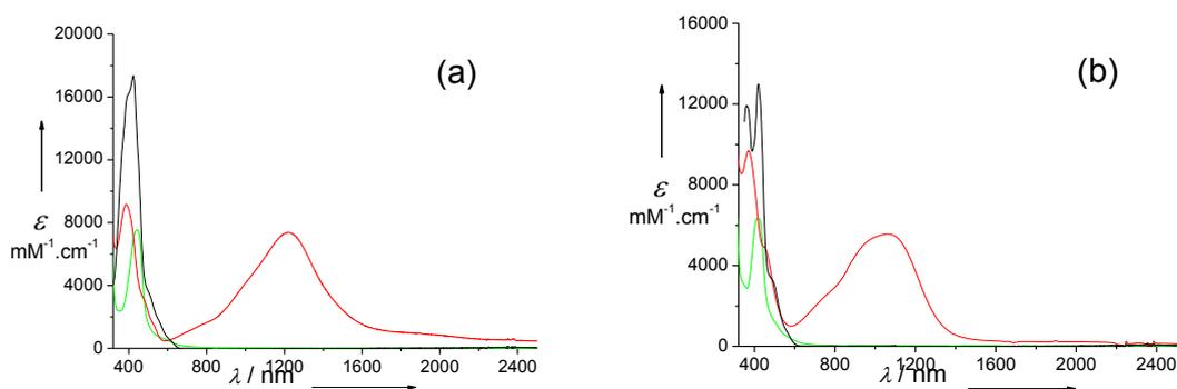
Figure 150: Spectres UV-Vis-NIR de solutions à 0.05 mM dans  $\text{CH}_2\text{Cl}_2$  des complexes neutres et oxydés à un électron : a)  $[\text{Co}(\text{I}^{\text{OMe}})]$  (noir),  $[\text{Co}(\text{I}^{\text{OMe}})(\text{im})_2]^+$  (vert) et  $[\text{Co}(\text{I}^{\text{OMe}})]^+$  (rouge); b)  $[\text{Co}(\text{I}^{\text{tBu}})]$  (noir),  $[\text{Co}(\text{I}^{\text{tBu}})(\text{im})_2]^+$  (vert) et  $[\text{Co}(\text{I}^{\text{tBu}})]^+$  (rouge).  $T = 298 \text{ K}$ .
