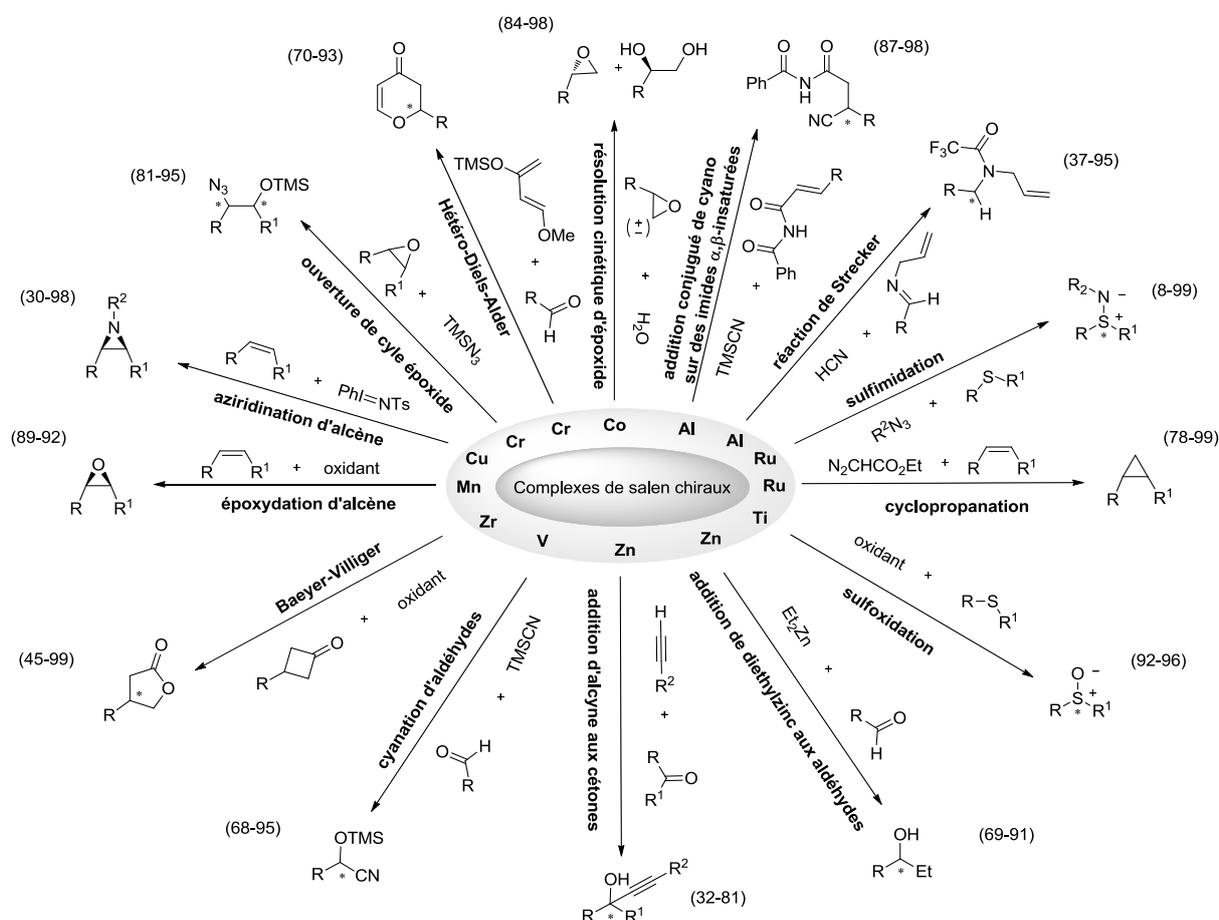
Figure 30: Types de réactions et excès énantiomères atteints (entre parenthèse) en utilisant des complexes chiraux de métal-salen comme catalyseurs.<sup>84</sup>
