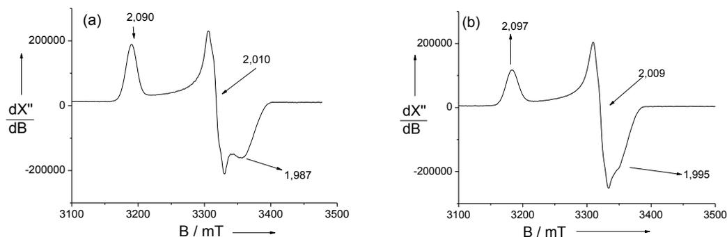
Figure 96: Spectres RPE en bande X de solutions à 0.5 mM des complexes monooxydés: a)  $[\text{Ni}(\text{1}_{\text{N}_4}^{\text{tBu}})^{\bullet}]^+$  et b)  $[\text{Ni}(\text{4}_{\text{N}_4}^{\text{tBu}})^{\bullet}]^+$  généré par électrochimie enregistrés à 100K dans  $\text{CH}_2\text{Cl}_2$ .
