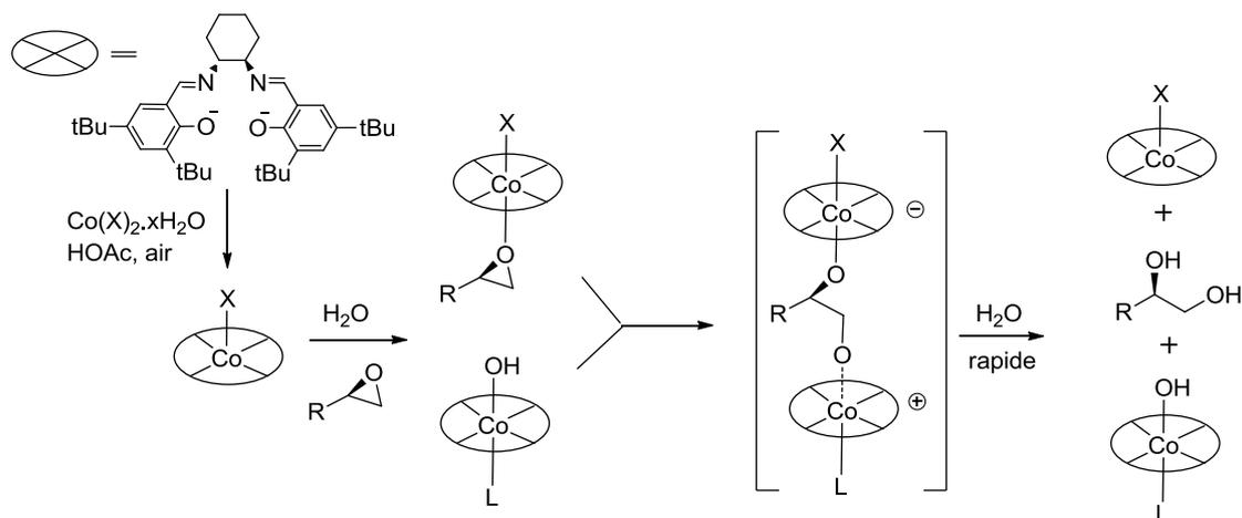
Figure 34: Processus bimétallique proposé pour l'HKR ( $\text{X} = \text{OAc}^-$ ,  $\text{Cl}^-$ ,  $\text{SbF}_6^-$  ou autre selon le sel métallique de départ utilisé,  $\text{L} =$  ligand exogène contenu dans le milieu).<sup>94</sup>
