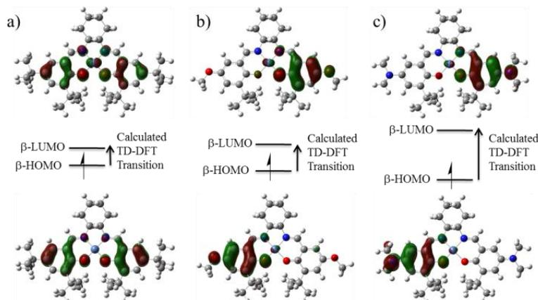
Figure 56: Attribution par TD-DFT des transitions calculées dans le NIR pour: a)  $[\text{Ni}^{\text{II}}(\text{1}^{\text{tBu}})^{\bullet}]^+$ , b)  $[\text{Ni}^{\text{II}}(\text{1}^{\text{OMe}})^{\bullet}]^+$  et c)  $[\text{Ni}^{\text{II}}(\text{1}^{\text{NMe}_2})^{\bullet}]^+$ .  $\beta$ -HOMO : orbitale la plus basse,  $\beta$ -LUMO : orbitale la plus haute
