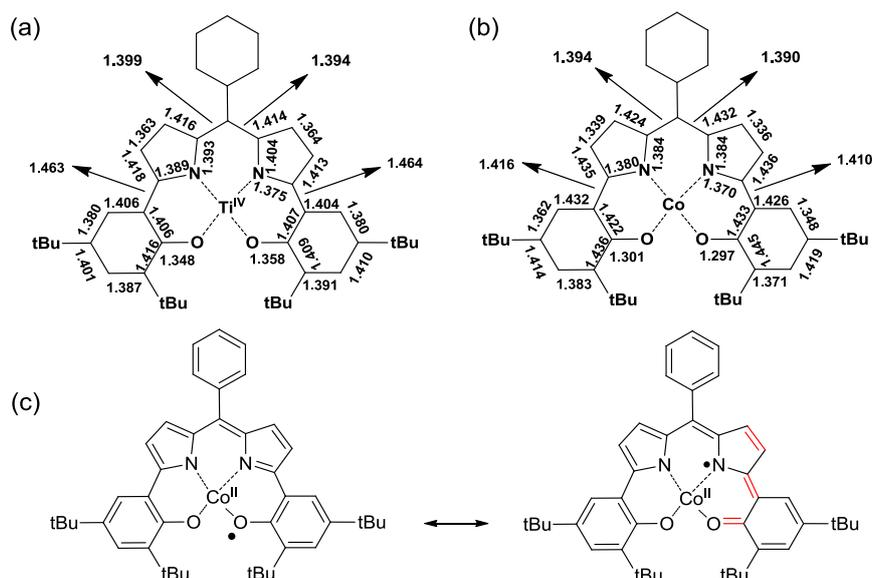
**Figure 183 :** Longueurs de liaison dans le complexe a)  $[\text{Ti}^{\text{IV}}(10)(\text{Cl})(\text{THF})]$  (cette représentation omet la coordination des ligands axiaux, avec une erreur de  $\pm 0.01$  Å), b)  $[\text{Co}(10)]$  (erreur de  $\pm 0.005$  Å) et c) représentation de deux formes mésomères de  $[\text{Co}^{\text{II}}(10)^{\bullet}]$  (liaisons possédant un caractère double liaison en rouge).
