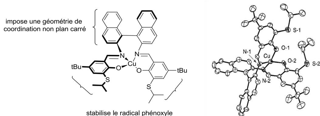
Figure 44: Représentation du complexe  $[\text{Cu}^{\text{II}}(18)]$  (à gauche) et de sa structure cristallographique par diffraction des rayons X (à droite).<sup>128</sup>
