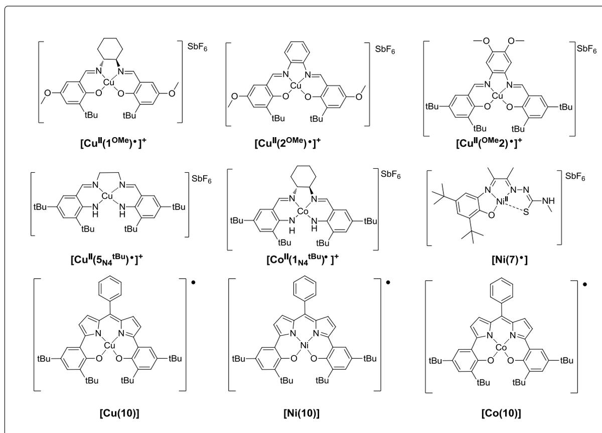
Figure 200: Représentation des complexes testés en catalyse pour l'oxydation de l'alcool benzylique.
