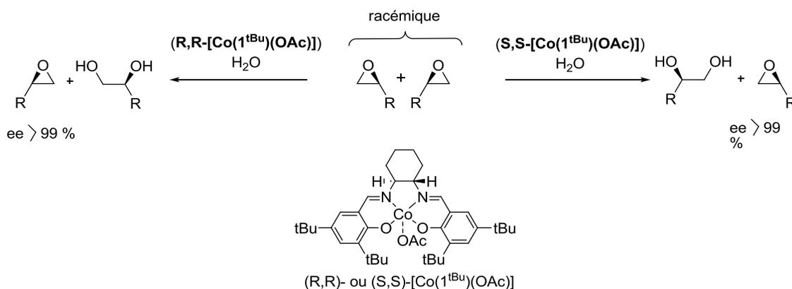
Figure 33: Résolution cinétique par hydrolyse (HKR) d'époxydes racémiques par le complexe [Co(1<sup>tBu</sup>)(OAc)].
