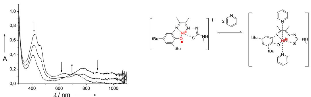
Figure 119: Titrage du complexe [Ni(7)<sup>•+</sup>] à 0.025mM dans  $\text{CH}_2\text{Cl}_2$  par la pyridine (de 0 à 20 équivalents molaires), T = 248 K, trajet optique 1 cm, les flèches indiquent l'évolution du spectre au cours du titrage.
