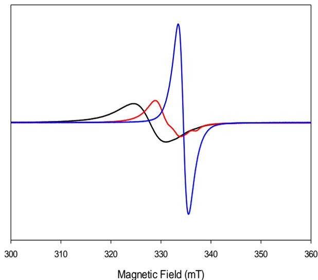
Annexe 1: Spectre RPE des composés  $[\text{Ni}^{\text{II}}(\mathbf{1}^{\text{tBu}})]^+$  (ligne noire),  $[\text{Ni}^{\text{II}}(\mathbf{1}^{\text{OMe}})]^+$  (ligne rouge) et  $[\text{Ni}^{\text{II}}(\mathbf{1}^{\text{NMe}_2})]^+$  (ligne bleu) dans  $\text{CH}_2\text{Cl}_2$  à 20 K.
