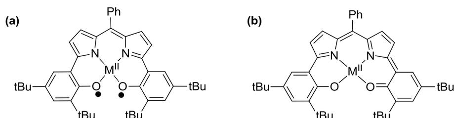
Figure 190: Formulations possibles du complexe dioxydé: a) ligand diradicalaire ( $[\text{Co}^{\text{II}}(10)^{\bullet\bullet}]^+$ ) et b) système à couche fermé ( $[\text{Co}^{\text{II}}(10)^{\text{ox}}]^+$ ).
