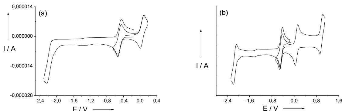
Figure 132: Courbes de voltamétrie cyclique de solutions à 0.5 mM des complexes [Ni(10)•] a) et [Cu(10)•] b) dans CH<sub>2</sub>Cl<sub>2</sub> contenant 0.1 M TBAP. Vitesse de balayage : 0.1 V.s<sup>-1</sup>, T=298 K. Les potentiels sont donnés par rapport au couple de référence Fc<sup>+</sup>/Fc.
