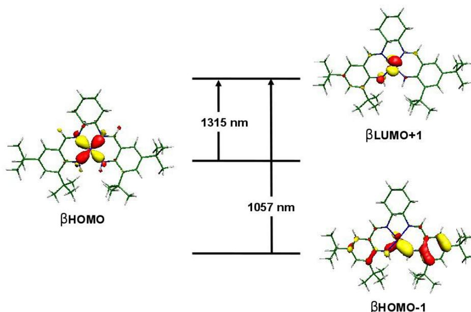
Figure 173: Attribution de la nature des transitions à basses énergie de  $[\text{Co}(\text{1}_{\text{N4}}^{\text{tBu}})]^+$  par TD-DFT (système considéré dans un état fondamental triplet en omettant le contre-ion  $\text{SbF}_6^-$ ).
