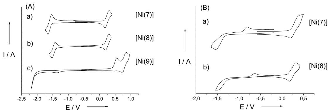
Figure 116: Courbes de voltamétrie cyclique de solutions à 1 mM des complexes (A) : a) [Ni(7)] b) [Ni(8)] et c) [Ni(9)] dans  $\text{CH}_2\text{Cl}_2$  anhydre et (B) a) [Ni(7)] et b) [Ni(8)] dans le THF anhydre, contenant 0.1 M de TBAP. Vitesse de balayage :  $0.1 \text{ V}\cdot\text{s}^{-1}$ ,  $T = 298 \text{ K}$ . Les potentiels sont donnés par rapport au couple de référence  $\text{Fc}^+/\text{Fc}$ .
