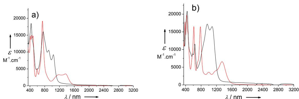
Figure 139: Spectres électroniques de solutions à 0.5 mM des complexes monooxydés  $[\text{Ni}(\text{10})^{\cdot}]$  a) et  $[\text{Cu}(\text{10})^{\cdot}]$  b) (lignes rouges), et des complexes dioxydés  $[\text{Ni}(\text{10})^{\text{ox}}]^+$  a) et  $[\text{Cu}(\text{10})^{\text{ox}}]^+$  b) générés par  $\text{AgSbF}_6$  (lignes noires) dans  $\text{CH}_2\text{Cl}_2$ . T = 298 K, trajet optique = 1.000 mm.
