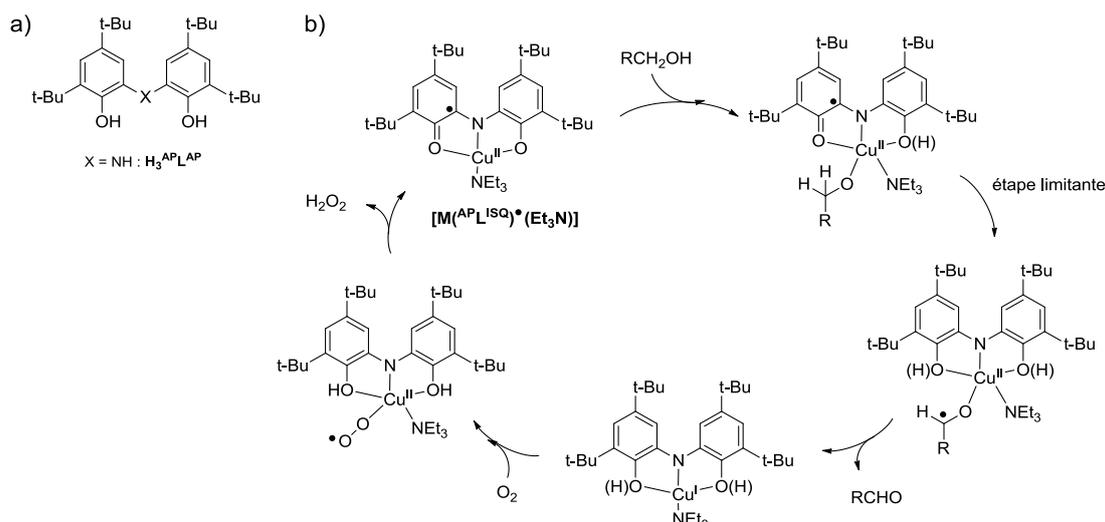
Figure 197: a) Ligand  $H_3^{APL^{AP}}$  et b) mécanisme proposé pour l'oxydation catalytique d'alcools primaires par  $[Cu^{II}(APL^{ISQ})\cdot(NEt_3)]$ . Les protons sont placés arbitrairement pour les intermédiaires réactionnels non caractérisés au niveau structural.
