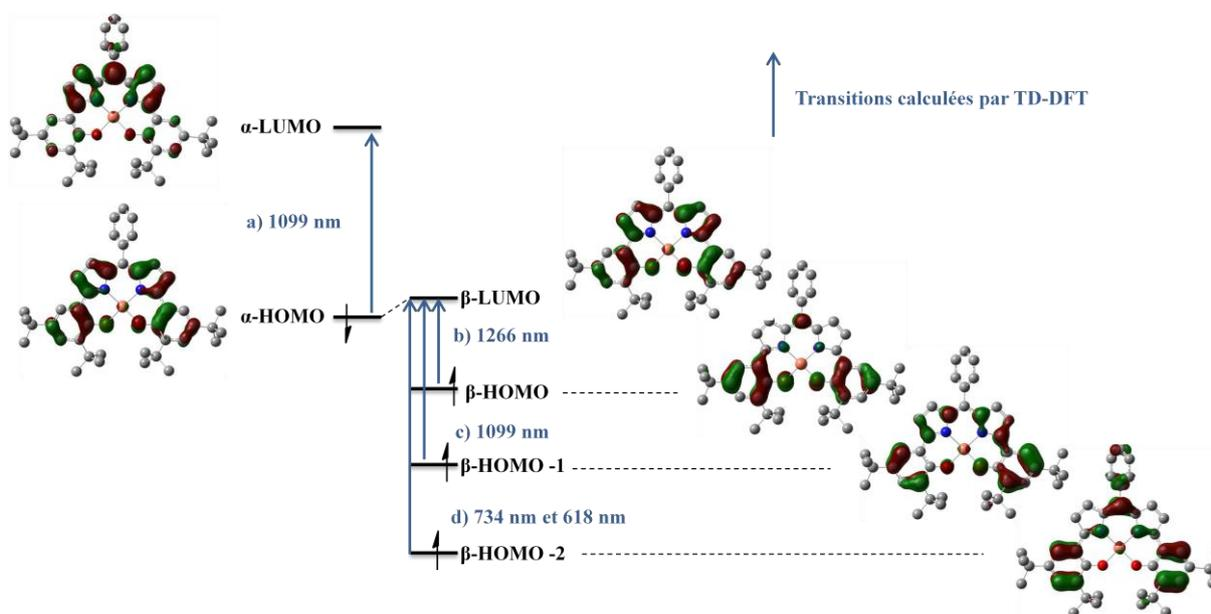
Figure 141:  $[\text{Cu}(10)^{\bullet}]$  : Attribution des transitions calculées par TD-DFT ( $S = 1$ , fonctionnelle B3LYP)
