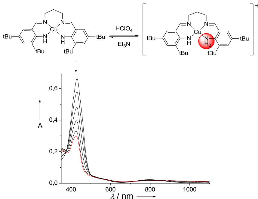
Annexe 3: Titration du complexe neutre  $[\text{Cu}(\text{4}_{\text{N4}}^{\text{tBu}})]$  (0.05 mM dans  $\text{CH}_2\text{Cl}_2$ ) par une solution de  $\text{HClO}_4$  (0.005 M dans  $\text{CH}_3\text{CN}$ ) de 0 jusqu'à 1 équivalent. Trajet optique 1.000 cm T = 298K. Les flèches indiquent l'évolution du spectre lors de l'ajout d'acide.
