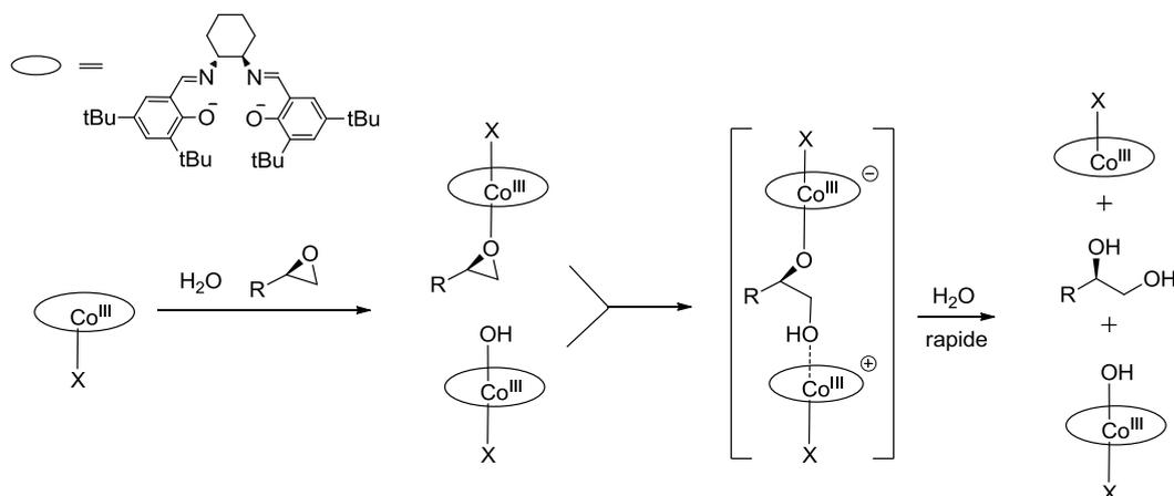
Figure 161: Processus bimétallique proposé dans la littérature pour l'HKR ( $\text{X} = \text{Cl}^-$  ou  $\text{SbF}_6^-$ )<sup>94</sup>
