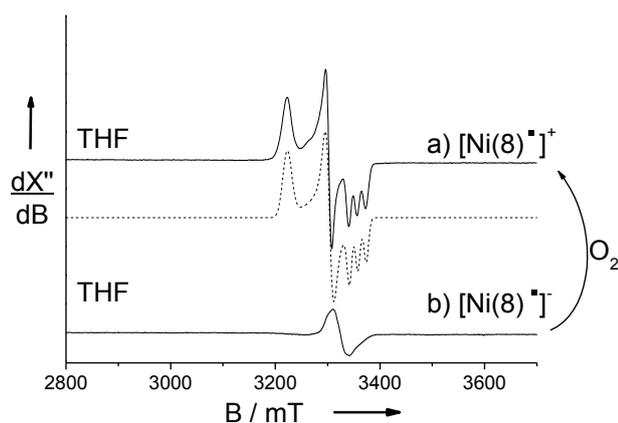
Figure 121 : Spectres RPE en bande X de solution à 4 mM enregistrés à 100K dans le THF : b)  $[\text{Ni}(8)^{\bullet}]^-$  (réduit chimiquement par NaHg en boîte à gant) et a) du même échantillon exposé 2 minutes à l'oxygène. Le spectre en pointillé représente la simulation du spectre a) en utilisant les paramètres détaillés dans le texte.
