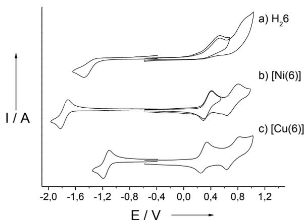
**Figure 103:** Courbes de voltamétrie cyclique de solutions à 1 mM contenant 0.1 M TBAP : a) H<sub>2</sub>6 dans CH<sub>2</sub>Cl<sub>2</sub>/DMF (1/1), b) [Ni(6)] et c) [Cu(6)] dans CH<sub>2</sub>Cl<sub>2</sub>. Vitesse de balayage : 0.1 V.s<sup>-1</sup>, T = 298 K. Les potentiels sont donnés par rapport au couple de référence Fc<sup>+</sup>/Fc.
