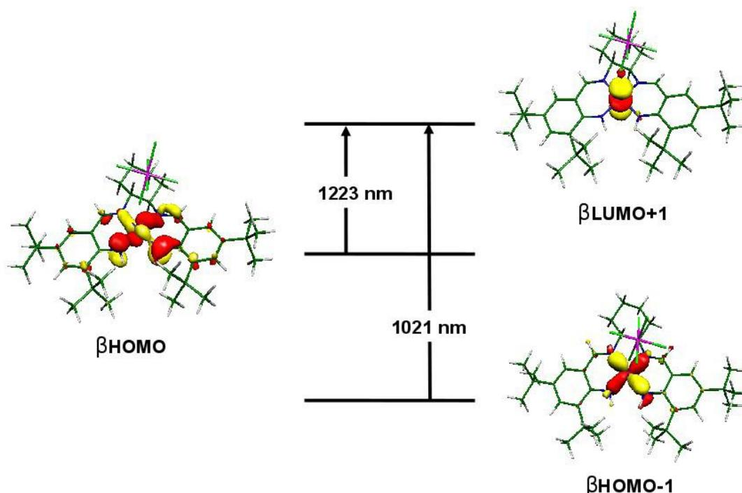
Annexe 5: Attribution de la nature des transitions à basse énergie de  $[\text{Co}(\text{1N}_4^{\text{tBu}})]^+$  par TD-DFT (système considéré dans un état fondamental triplet en incluant le contre-ion  $\text{SbF}_6^-$ ).
