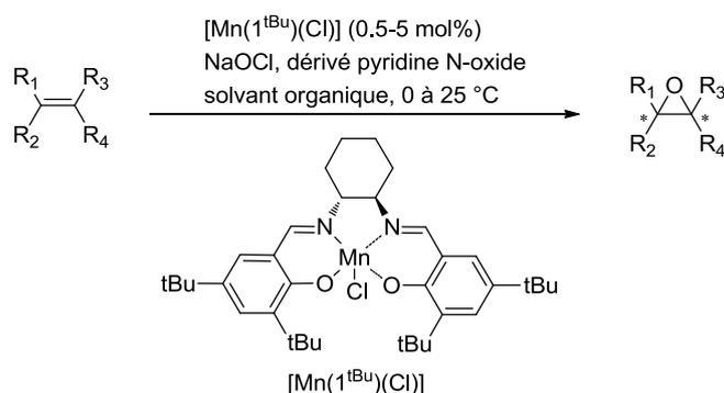
Figure 31: Conditions générales pour l'époxydation asymétrique d'oléfines conjuguées catalysée par  $[\text{Mn}(\text{1}^{\text{tBu}})(\text{Cl})]$ .<sup>91</sup>
