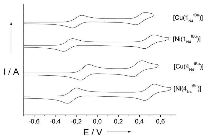
Figure 91: Courbes de voltamétrie cyclique de solutions à 0.5 mM des complexes  $[Cu(1_{N4}^{tBu})]$ ,  $[Ni(4_{N4}^{tBu})]$ ,  $[Cu(4_{N4}^{tBu})]$  et  $[Ni(1_{N4}^{tBu})]$  dans  $CH_2Cl_2$  contenant 0.1 M TBAP. Vitesse de balayage :  $0.1 \text{ V}\cdot\text{s}^{-1}$ ,  $T=298 \text{ K}$ . Les potentiels sont donnés par rapport au couple de référence  $Fc^+/Fc$ .
