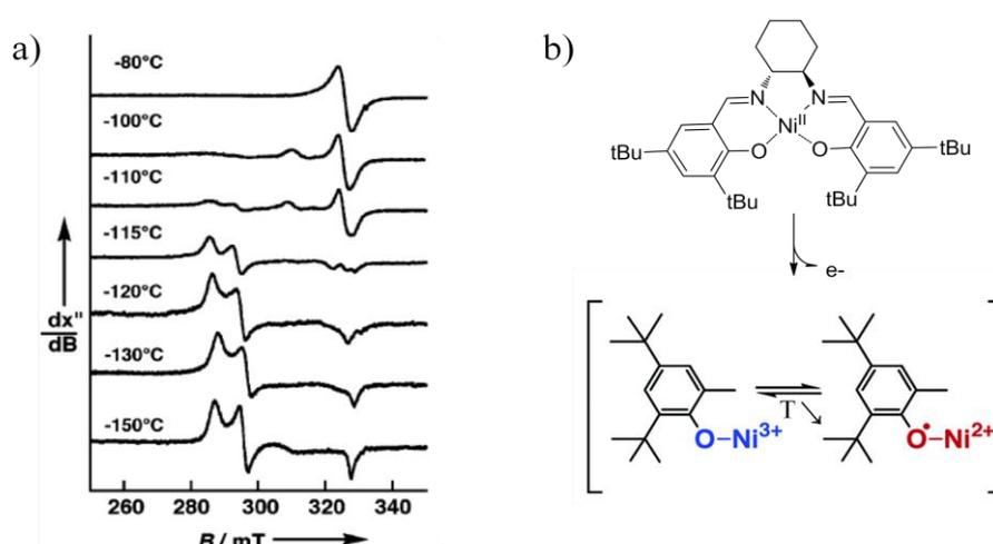
Figure 39: a) Spectre RPE en bande X en fonction de la température de  $[\text{Ni}^{\text{II}}(1^{\text{tBu}})]$  monoxydé à 0.5 mM dans  $\text{CH}_2\text{Cl}_2$ . Puissance microonde : 1 mW, amplitude de modulation : 0.63 mT. b) représentation des deux tautomères de valence en équilibre dans  $\text{CH}_2\text{Cl}_2$ .
