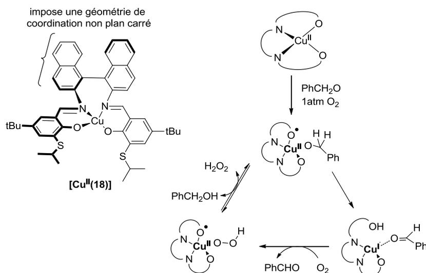
Figure 199: Cycle catalytique proposé pour le complexe  $[\text{Cu}^{\text{II}}(18)]^+$ .
