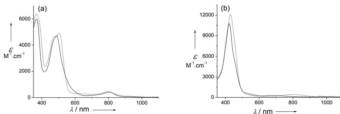
Figure 86: Spectres électroniques de solution à 0.05 mm : a)  $[\text{Ni}(\text{1}_{\text{N}_4}^{\text{tBu}})]$  (ligne pleine),  $[\text{Ni}(\text{4}_{\text{N}_4}^{\text{tBu}})]$  (ligne en pointillée), b)  $[\text{Cu}(\text{1}_{\text{N}_4}^{\text{tBu}})]$  (ligne pleine),  $[\text{Cu}(\text{4}_{\text{N}_4}^{\text{tBu}})]$  (ligne en pointillée) dans  $\text{CH}_2\text{Cl}_2$ , trajet optique 1.000 cm T = 298K.
