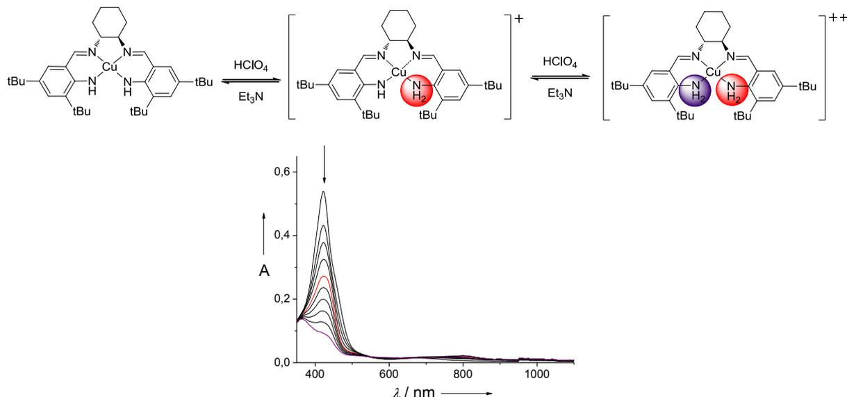
**Figure 89:** Titrage du complexe neutre  $[\text{Cu}(1_{\text{N}_4}^{\text{tBu}})]$  (0.05 mM dans  $\text{CH}_2\text{Cl}_2$ ) par une solution de  $\text{HClO}_4$  (0.005 M dans  $\text{CH}_3\text{CN}$ ) : a) de 0 à 1 équivalent et b) de 1 à 2 équivalents de  $\text{HClO}_4$ . Trajet optique 1.000 cm T = 298K. Les flèches indiquent l'évolution du spectre lors de l'ajout d'acide.
