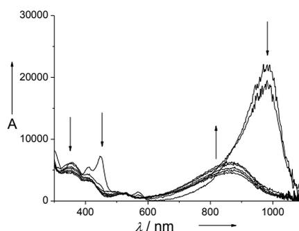
Figure 176: Titrage d'une solution à 0.05 mM dans  $\text{CH}_2\text{Cl}_2$  de  $[\text{Co}(\text{1}_{\text{N}_4}^{\text{tBu}})]^+$  généré par électrochimie de 0 à 74 équivalents de pyridine. Les flèches indiquent l'évolution du spectre au cours des ajouts. Trajet optique = 1.000 cm. T = 233 K.
