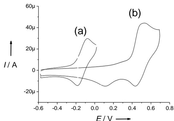
Figure 71: Courbes de voltamétrie cyclique de solutions à 1 mM des complexes (a) [Ni(3)] et (b) [Ni(3H)]<sup>+</sup> dans CH<sub>2</sub>Cl<sub>2</sub> (+ 0.1 M TBAP). Vitesse de balayage: 0.1 V s<sup>-1</sup>, T = 298 K. Les potentiels sont donnés par rapport au couple Fc<sup>+</sup>/Fc.
