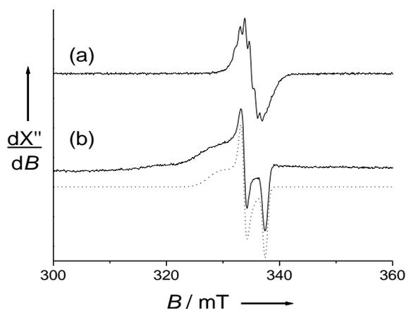
**Figure 73:** Spectres RPE en bande X de solution à 1mM dans  $\text{CH}_2\text{Cl}_2$  (contenant 0.1 M TBAP) de (a)  $[\text{Ni}(3)]^+$  et (b)  $[\text{Ni}(3\text{H})]^{2+}$ . Les lignes pleines représentent les spectres expérimentaux, la ligne en pointillé représente la simulation réalisée en utilisant les paramètres donnés dans le texte.  $T = 100$  K, fréquence microonde 9.42 GHz, puissance 20 mW, modulation de fréquence 100 KHz, amplitude 0.04 mT (a) et 0.16 mT (b).
