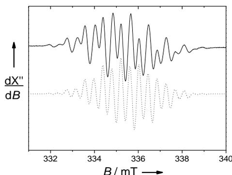
Figure 74: Spectre RPE isotrope d'une solution à 1 mM dans  $\text{CH}_2\text{Cl}_2$  (contenant 0.1 M TBAP) de  $[\text{Ni}(3')]^+$ . Ligne pleine: spectre expérimental, ligne en pointillés: simulation réalisée en utilisant les paramètres donnés dans le texte.  $T = 223 \text{ K}$ , fréquence microonde 9.42 GHz, puissance 20 mW, modulation de fréquence 100 KHz, amplitude 0.1 mT.
