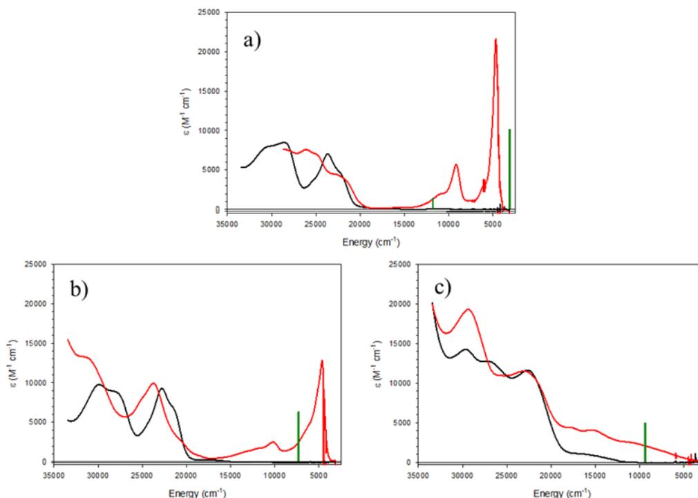
Figure 55: Spectres UV-vis-proche IR des complexes de Ni (neutre: ligne noire; monoxydé: ligne rouge): a)  $[\text{Ni}^{\text{II}}(\mathbf{1}^{\text{tBu}})]$  et  $[\text{Ni}^{\text{II}}(\mathbf{1}^{\text{tBu}})]^{\bullet+}$ ; b)  $[\text{Ni}^{\text{II}}(\mathbf{1}^{\text{OMe}})]$  et  $[\text{Ni}^{\text{II}}(\mathbf{1}^{\text{OMe}})]^{\bullet+}$ ; c)  $[\text{Ni}^{\text{II}}(\mathbf{1}^{\text{NMe}_2})]$  et  $[\text{Ni}^{\text{II}}(\mathbf{1}^{\text{NMe}_2})]^{\bullet+}$ .
