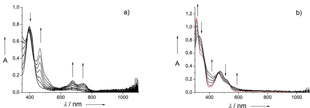
**Figure 105: Spectres électroniques du titrage d'une solution du complexe neutre  $[\text{Ni(6)}]$  à 0.05mM par le  $\text{TPA.Cl}_6$  de 0 à 1 équivalent a) et du complexe neutre  $[\text{Cu(6)}]$  à 0.05mM par le CAN de 0 à 1 équivalent b), dans  $\text{CH}_2\text{Cl}_2$ .  $T = 268\text{ K}$ , trajet optique = 1.000 cm (les flèches indiquent l'évolution des spectres au cours du titrage).**
