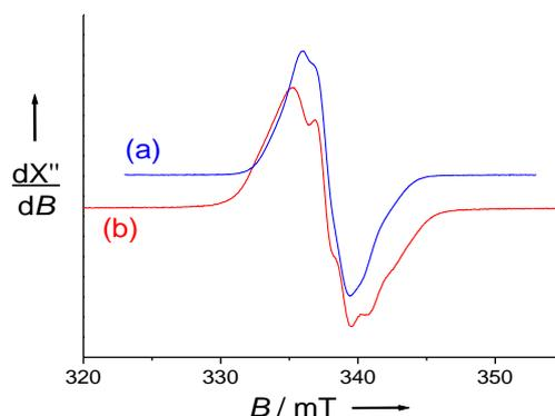
Figure 158: Spectres RPE en bande X de solutions à 0.5 mM dans  $\text{CH}_2\text{Cl}_2$  (+ 0.1 M TBAP) des dications générés par électrochimie a)  $[\text{Co}(\text{1}^{\text{OMe}})]^{2+}$  et b)  $[\text{Co}(\text{1}^{\text{tBu}})]^{2+}$ . Freq. Microonde: 9.45 GHz; Puissance: 5.5 mW; Amp. Mod. 0.1 mT, Freq. 100 KHz.  $T = 100$  K.
