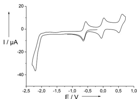
Figure 188: Courbe de voltamétrie cyclique d'une solution à 0.5 mM de  $[\text{Co}^{\text{II}}(10)^{\bullet}]$  dans  $\text{CH}_2\text{Cl}_2$  (+ 0.1 M TBAP). Vitesse de balayage :  $0.1 \text{ V}\cdot\text{s}^{-1}$ ,  $T = 298 \text{ K}$ . Les potentiels sont donnés par rapport au couple de référence  $\text{Fc}^+/\text{Fc}$ .
