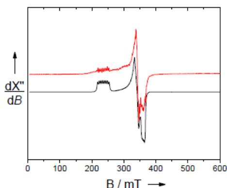
Figure 148: Spectre RPE en bande X de [Co(1<sup>OMe</sup>)] en solution à 1mM dans CH<sub>2</sub>Cl<sub>2</sub>. Ligne rouge : spectre expérimental, ligne noire : simulation en utilisant les paramètres donnés dans le texte. Freq Microonde : 9.45 GHz, Puissance : 5.5 mW ; Mod. Amp : 0.1 mT, Freq : 100 KHz ; T = 10 K.
