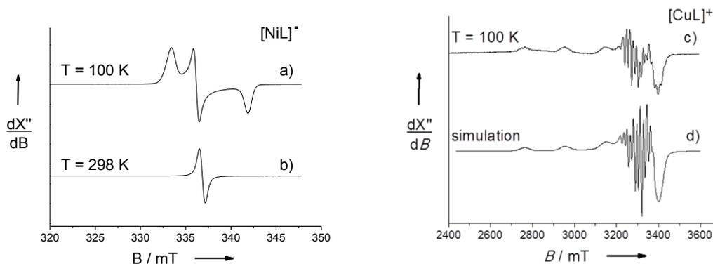
**Figure 137:** Spectres RPE en bande X de solutions à 0.5 mM dans  $\text{CH}_2\text{Cl}_2$  anhydre des complexes : a) monoxydé  $[\text{Ni}(10)^{\bullet}]$  enregistré à 100K et b) enregistré à 298 K ; et c) dioxydé  $[\text{Cu}(10)^{\text{ox}}]^+$  généré par électrochimie (+ 0.1M TBAP) enregistré à 100 K. Le spectre d) représente la simulation du spectre c) en utilisant les paramètres détaillés dans le texte.
