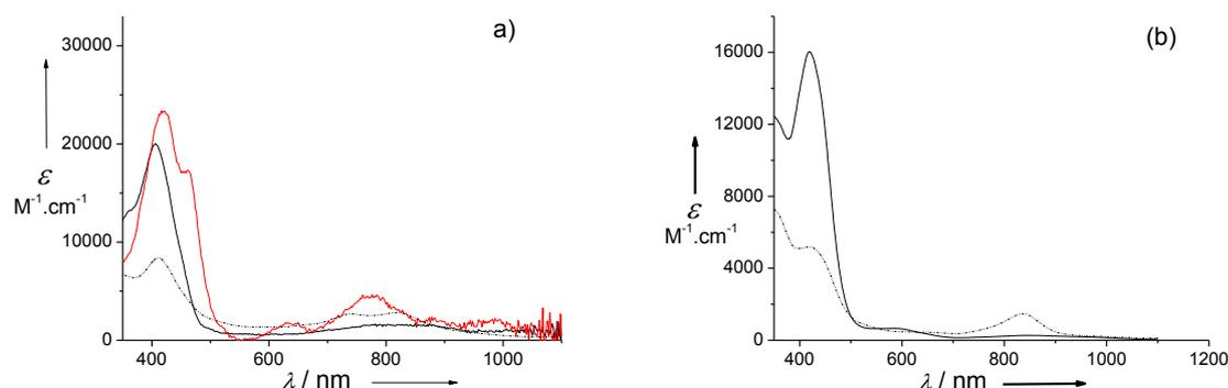
Figure 118: Spectres électroniques de solutions à 0.05 mM des complexes neutres a) [Ni(7)] et b) [Ni(8)] (lignes noires) et du complexe monooxydé [Ni(7) $\cdot^+$ ] générée par électrochimie (ligne rouge) dans  $\text{CH}_2\text{Cl}_2$   $T=248\text{K}$ , et des espèces réduites chimiquement par un amalgame de sodium ( $\text{NaHg}$ ) [Ni(7) $\cdot^-$ ] et [Ni(8) $\cdot^-$ ] sous atmosphère inerte dans le THF (lignes noires en pointillées),  $T=298\text{K}$ , trajet optique=1.000 cm.
