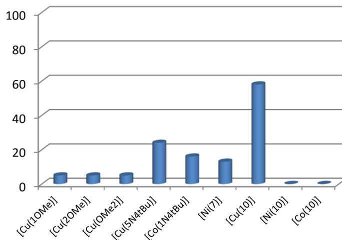
Figure 201 : Pourcentage d'alcool benzylique transformé en benzaldéhyde détecté par GC. Complexe 1 mM, alcool benzylique 0.1 M, tBuOK 20 mM, dichloromethane 3 mL, 2 bars d'O<sub>2</sub>, 25°C, 20 heures.
