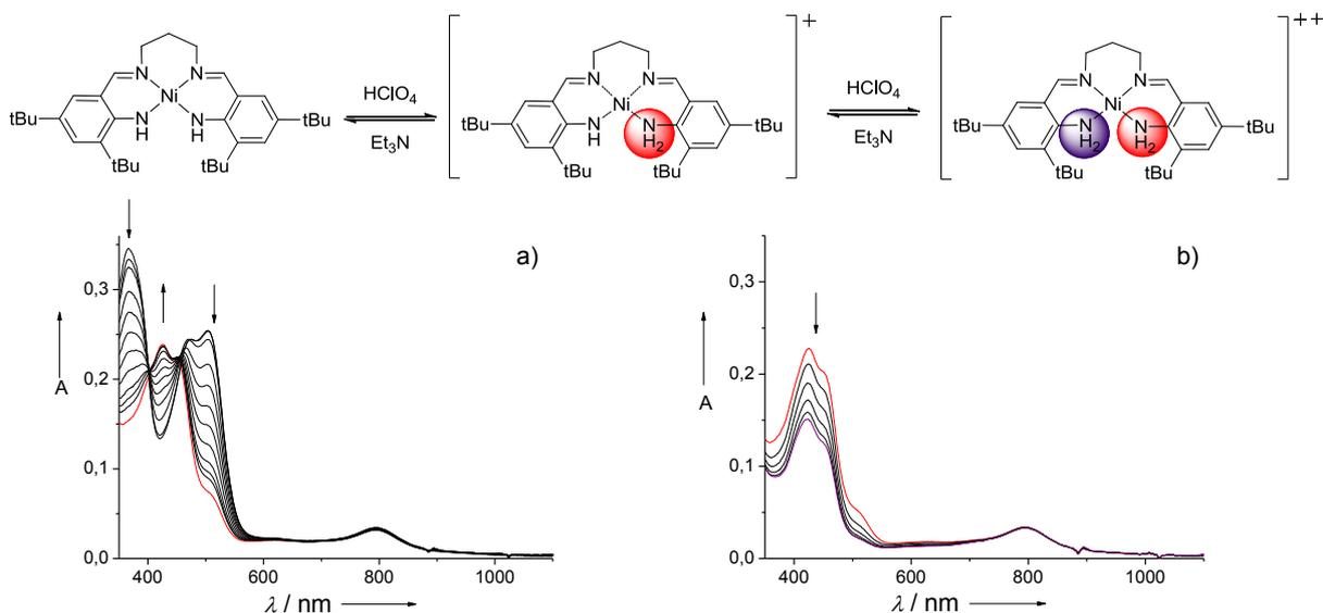
Annexe 2: Titrage du complexe neutre  $[\text{Ni}(\mathbf{4N}_4^{\text{tBu}})]$  (0.05 mM dans  $\text{CH}_2\text{Cl}_2$ ) par une solution de  $\text{HClO}_4$  (0.005 M dans  $\text{CH}_3\text{CN}$ ) de 0 jusqu'à 1 équivalent a) puis jusqu'à 2 équivalents b). Trajet optique 1.000 cm T = 298K. Les flèches indiquent l'évolution du spectre lors de l'ajout d'acide.
