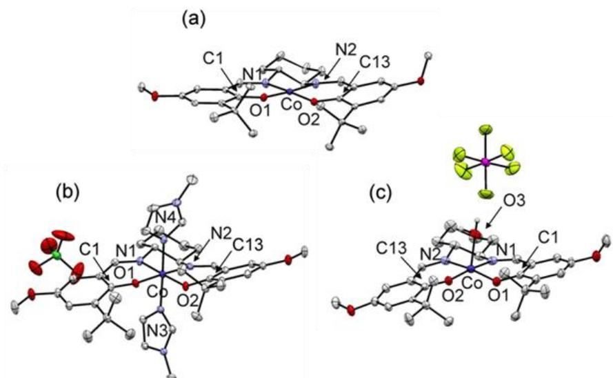
**Figure 147:** Structures cristallographiques obtenues par diffraction des rayons X de (a)  $[\text{Co}(\mathbf{1}^{\text{OMe}})]$ ; (b)  $[\text{Co}(\mathbf{1}^{\text{OMe}})(\text{im})_2]^+$ ; (c)  $[\text{Co}(\mathbf{1}^{\text{OMe}})]^+$  (ellipsoïdes à 30 %). Les atomes d'hydrogène sont omis à l'exception de la molécule d'eau coordonnée dans  $[\text{Co}(\mathbf{1}^{\text{OMe}})]^+$ .
