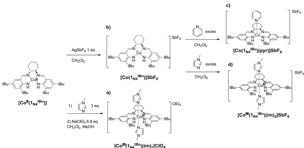
Figure 164 : Synthèse des complexes  $[\text{Co}(\text{1N}_4^{\text{tBu}})]\text{SbF}_6$ ,  $[\text{Co}^{\text{III}}(\text{1N}_4^{\text{tBu}})(\text{im})_2]^+$  et  $[\text{Co}(\text{1N}_4^{\text{tBu}})(\text{pyr})]^+$
