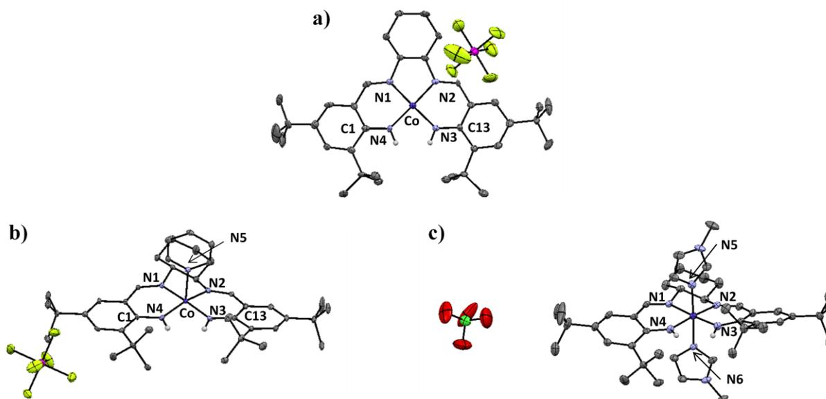
Figure 174 : Structures cristallographiques des complexes monoxydés  $[\text{Co}(\text{1}_{\text{N}_4}^{\text{tBu}})]^+.\text{SbF}_6^-$ ,  $[\text{Co}(\text{1}_{\text{N}_4}^{\text{tBu}})(\text{pyr})]^+.\text{SbF}_6^-$  et  $[\text{Co}(\text{1}^{\text{tBu}})(\text{im})_2]^+.\text{ClO}_4^-$  (ellipsoïdes à 30 %). Pour plus de clarté, les atomes d'hydrogène sont omis sauf pour les phénylamidures.
