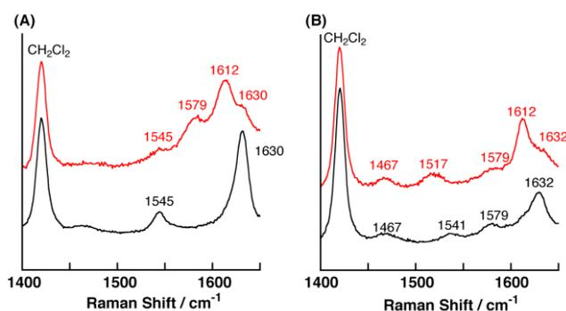
Figure 54: Spectres de Résonance Raman des complexes  $[\text{Ni}^{\text{II}}(\text{1}^{\text{OMe}})]$  (A) et  $[\text{Ni}^{\text{II}}(\text{1}^{\text{NMe2}})]$  (B) et de leurs espèces monoxydées enregistrés à la longueur d'onde d'excitation  $\lambda_{\text{ex}} = 413.1 \text{ nm}$  à  $-60 \text{ }^{\circ}\text{C}$ . Lignes noires : complexes neutres, lignes rouges : complexes monoxydés.
